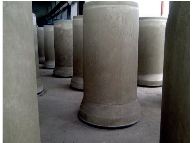
混凝土管道固化
