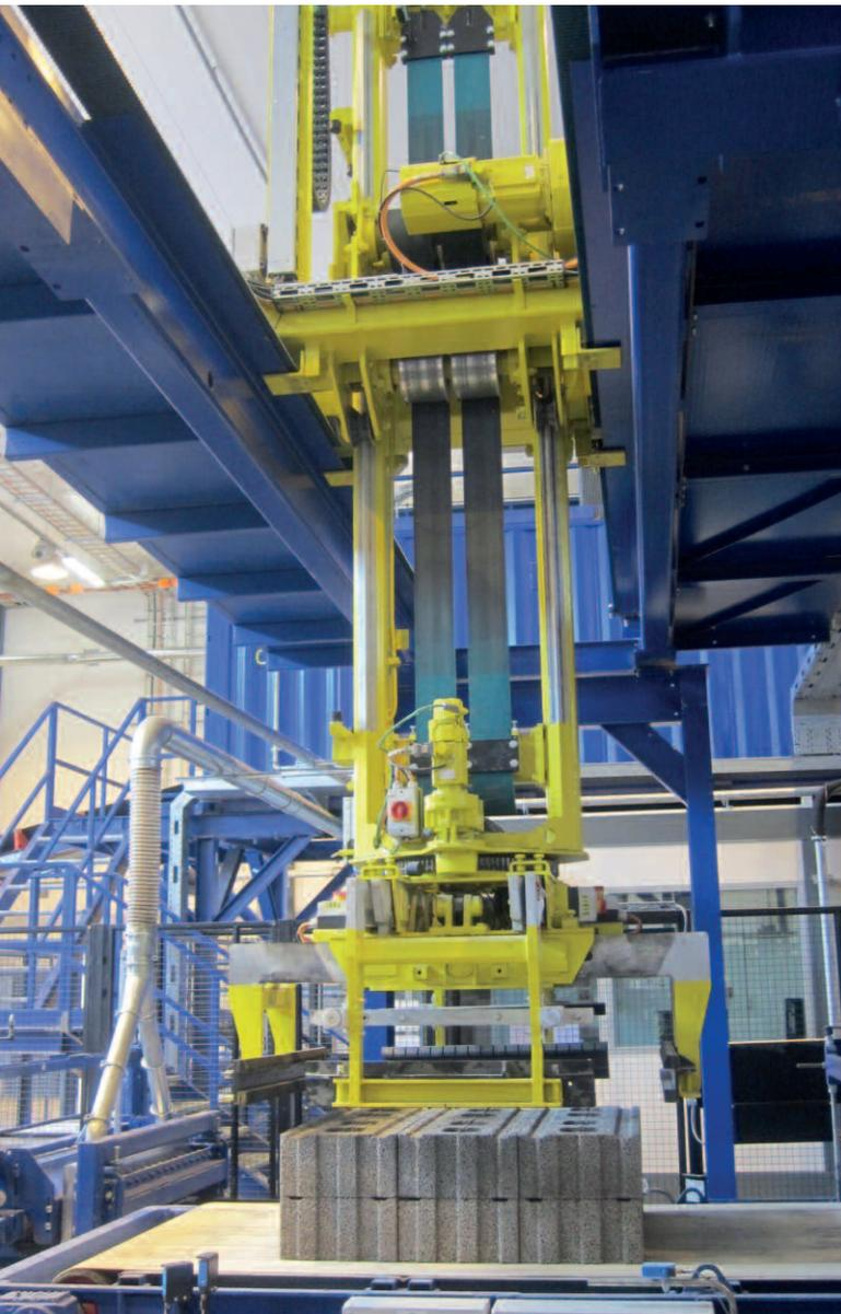
Вращающееся грейферное устройство с захватами и электрическим приводом
