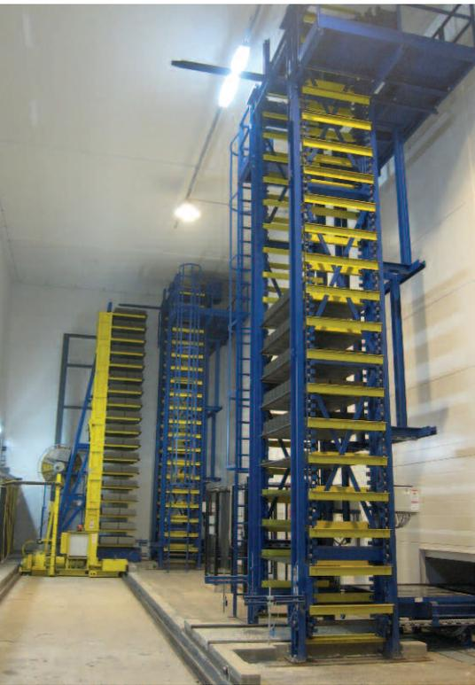
Поддача отвердевшей продукции на подъемное устройство на участке сухой обработки
