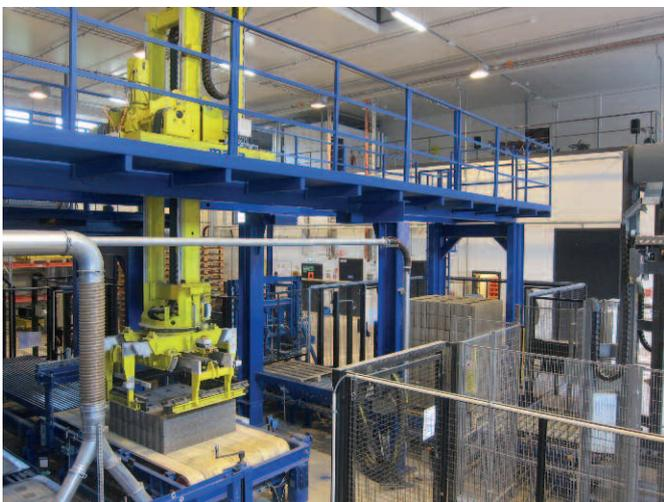
По два ряда блоков, сформированных с помощью сдвигающего устройства, захватывает второй робот и формирует из них пакет блоков
