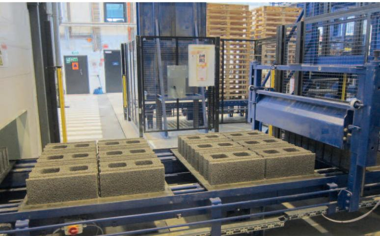
Отвердевшие бетонные блоки на участке сухой обработки
