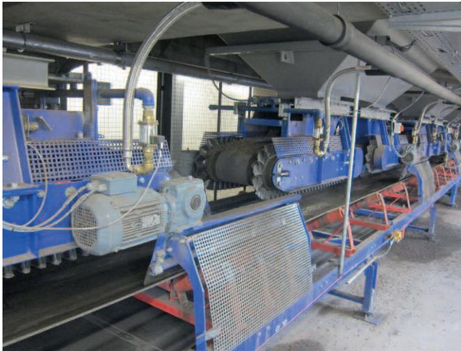
Силосы имеют два разгрузочных отверстия. Дозирование осуществляется по объему. На каждой ленте установлена распылительная установка для увлажнения сырья
