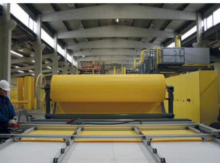
Полотна футеровки ПЭТ отрезаются точно в соответствии с номинальным диаметром и конструктивной длиной
