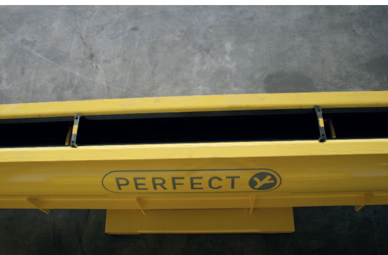
Боковые крепления с индивидуальной юстировкой позволяют выпускать трубы Perfect Pipe индивидуальной длины
