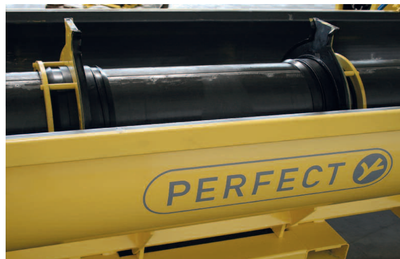
Форма для фасонной трубы со свободно регулируемыми боковыми запорами
