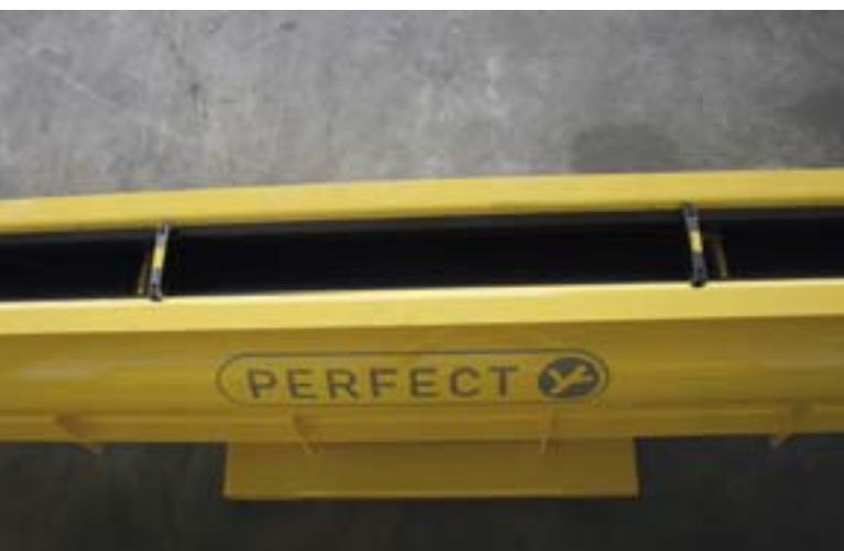
Regulowane poprzeczne ograniczniki umożliwiają dokładne dostosowanie długości rury przegubowej Perfect Pipe.
