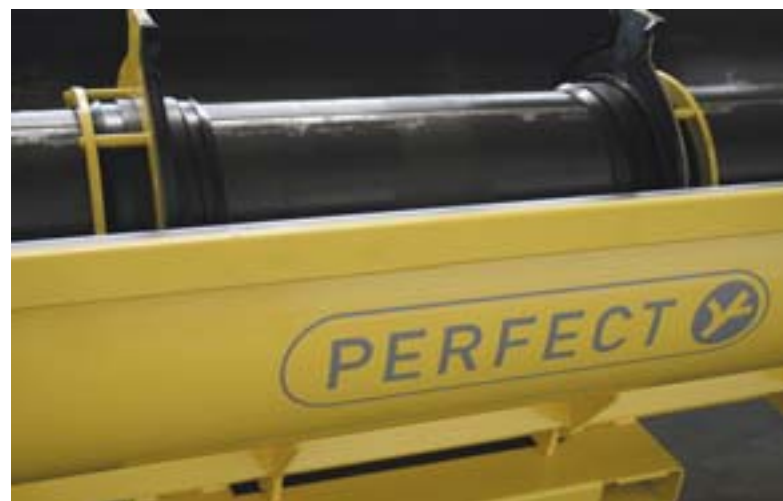
Forma z dowolnie regulowanymi poprzecznymi ogranicznikami umożliwia wykonanie rury przegubowej o dokładnej długości.
