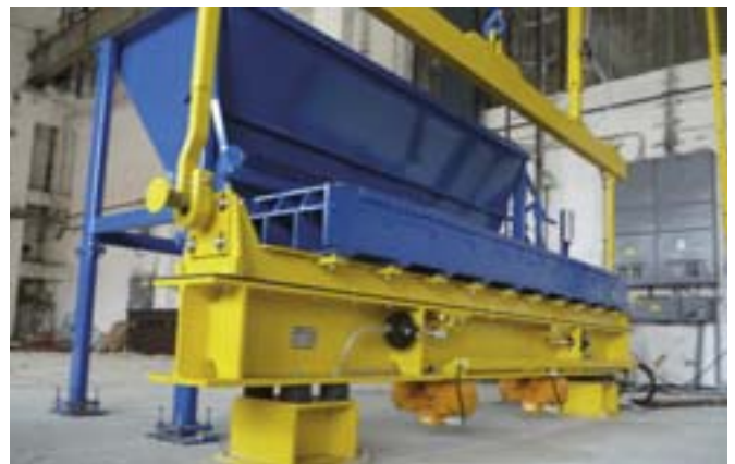
Stół wibracyjny z dwoma silnikami i pneumatycznymi łapami blokującymi.
