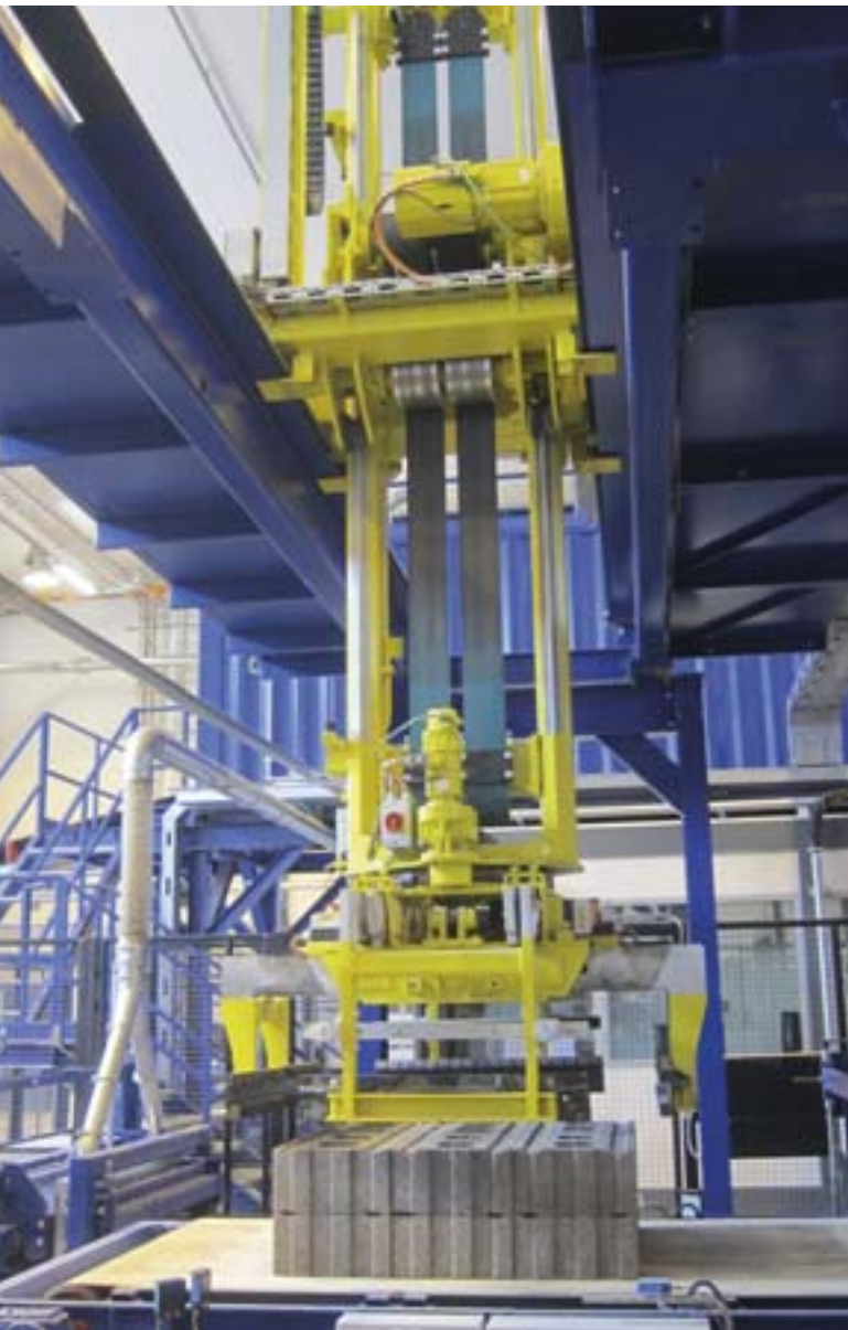
Chwytnak z mechanizmem obrotowym i czterostronnymi szczękami napędzanymi elektrycznie.
