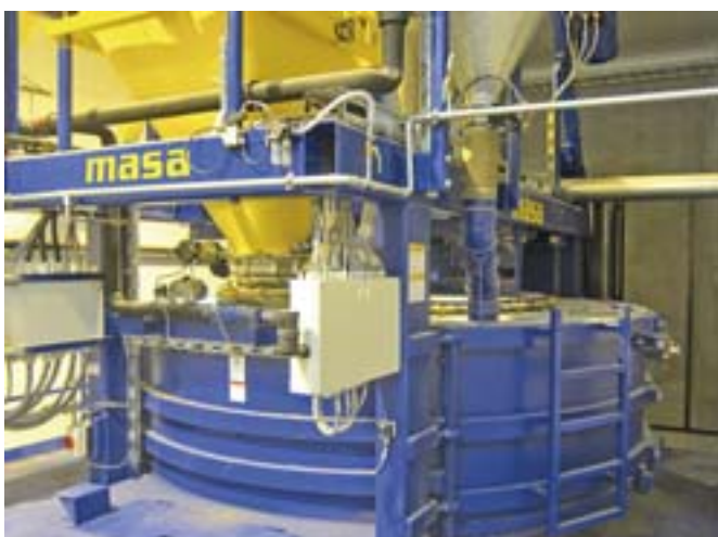
Mieszarka horyzontalna o wymuszonym obiegu typu PH 3000/4500 firmy Masa.
