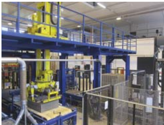
Drugi robot z chwytakiem zabiera po dwie warstwy wyrobów, które zostały wcześniej ułożone dublownikiem, i układa je w pakiety na znajdującym się za nim przenośniku.
