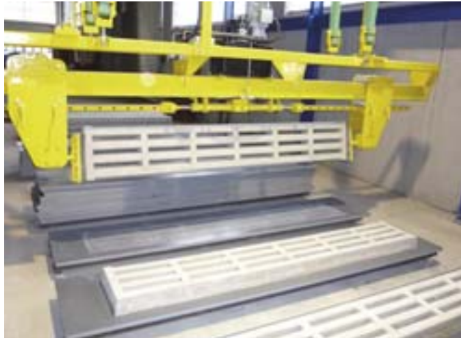
Suwica L3 do odbierania wyrobów z chwytakiem hydraulicznym.
