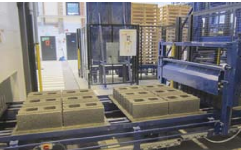
Stwardniałe bloczki z betonu lekkiego na linii suchej.
