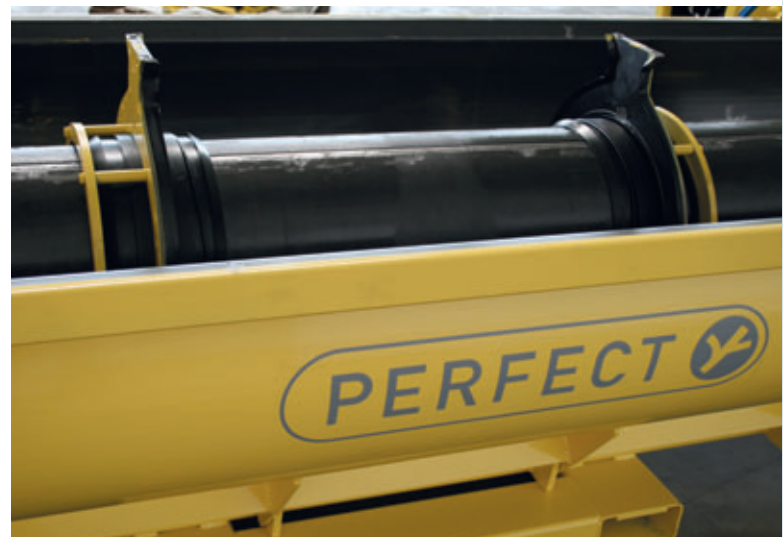
Particolare di uno stampo per tubo di raccordo con chiusure laterali regolabili.
