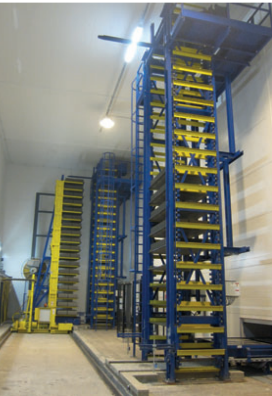
Consegna dei manufatti maturati in calcestruzzo al discensore sul lato asciutto.
