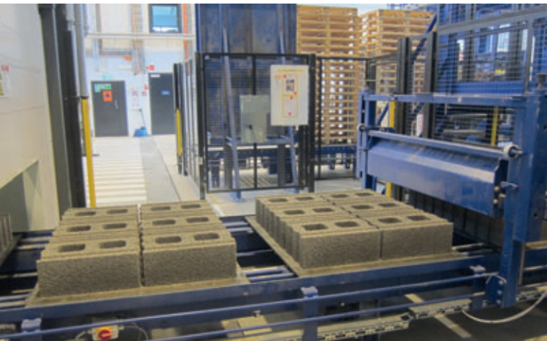
Blocchi in calcestruzzo maturati sul lato asciutto
