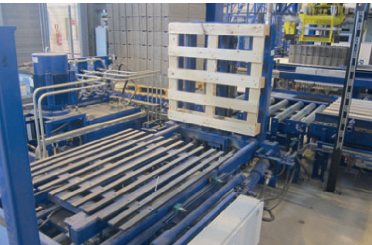
Con il banco ribaltabile è possibile creare i pacchi di blocchi „orizzontalmente“.
