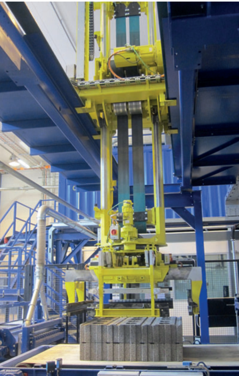
L'apparecchiatura a benna e pinza, appesa girevolmente, con una pinza su quattro lati, azionata elettricamente
