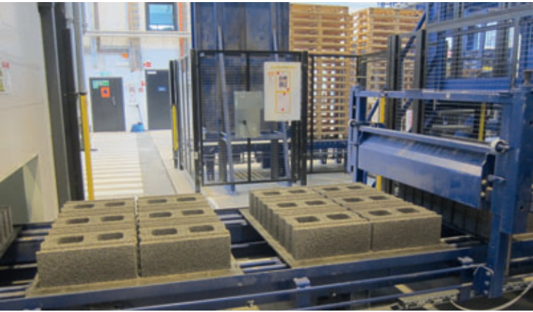
Blocs de béton durcis, côté sec
