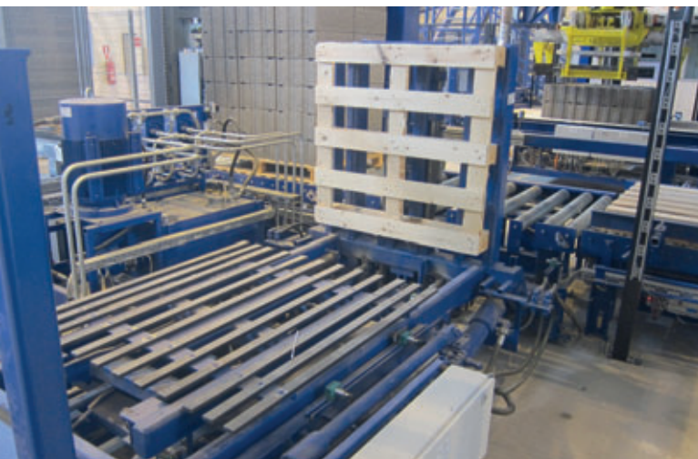
Avec la table basculante, des paquets de blocs peuvent être formés en position horizontale.
