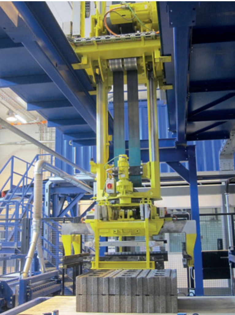
Le dispositif de préhension et de serrage accroché et rotatif, avec pinces sur quatre côtés, à entraînement électrique
