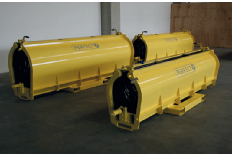
Pour la production de tuyaux de raccordement de diamètre 250 à 600, des moules sont disponibles dans chaque diamètre
