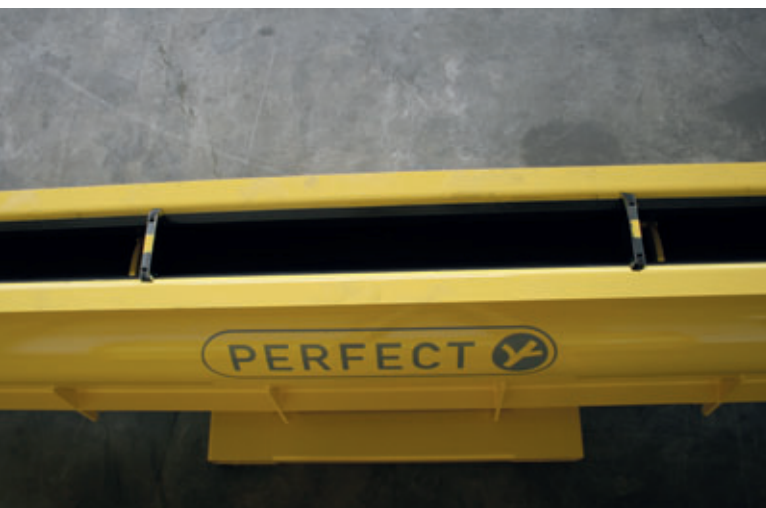
Les fermetures latérales réglables individuellement permettent d'obtenir des longueurs sur mesure lors de la fabrication des tuyaux de raccordement Perfect Pipe.
