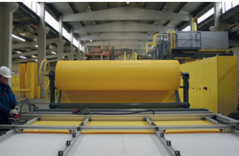
Les bandes de revêtement inliner sont sectionnées avec précision, en fonction du diamètre nominal et de la longueur du tuyau
