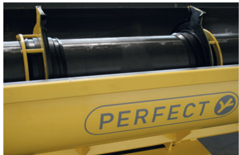
Aperçu de l'intérieur d'un moule pour tuyau de raccordement avec fermetures latérales réglables.
