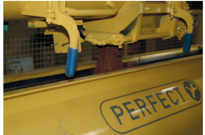
Le dispositif de coulage spécialement conçu pour la fabrication des tuyaux Perfect Pipe.
