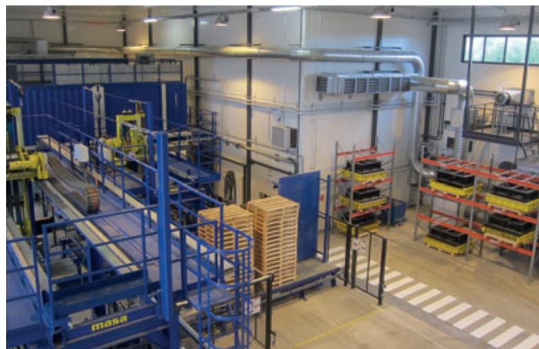
Die Winter in Finnland sind hart und lang. Um trotzdem durchgehend produzieren zu können, wurde die komplette Halle mit schwerentflammaren Isolierelementen verkleidet.
