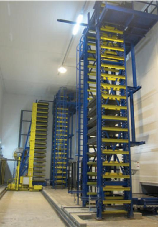
Übergabe von ausgehärteten Betonwaren an die Senkleiter auf der Trockenseite
