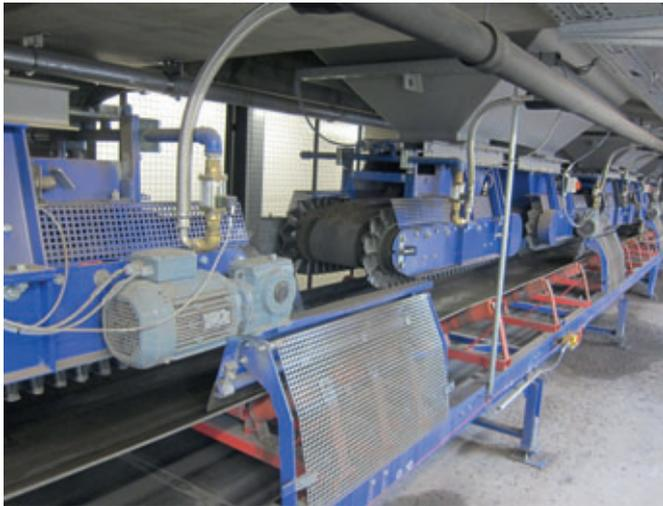
Die Silos verfügen über zwei Austragsöffnungen. Die Dosierung erfolgt volumetrisch. An jedem Band ist ein Sprühsystem zur Befeuchtung der Rohstoffe angebracht.
