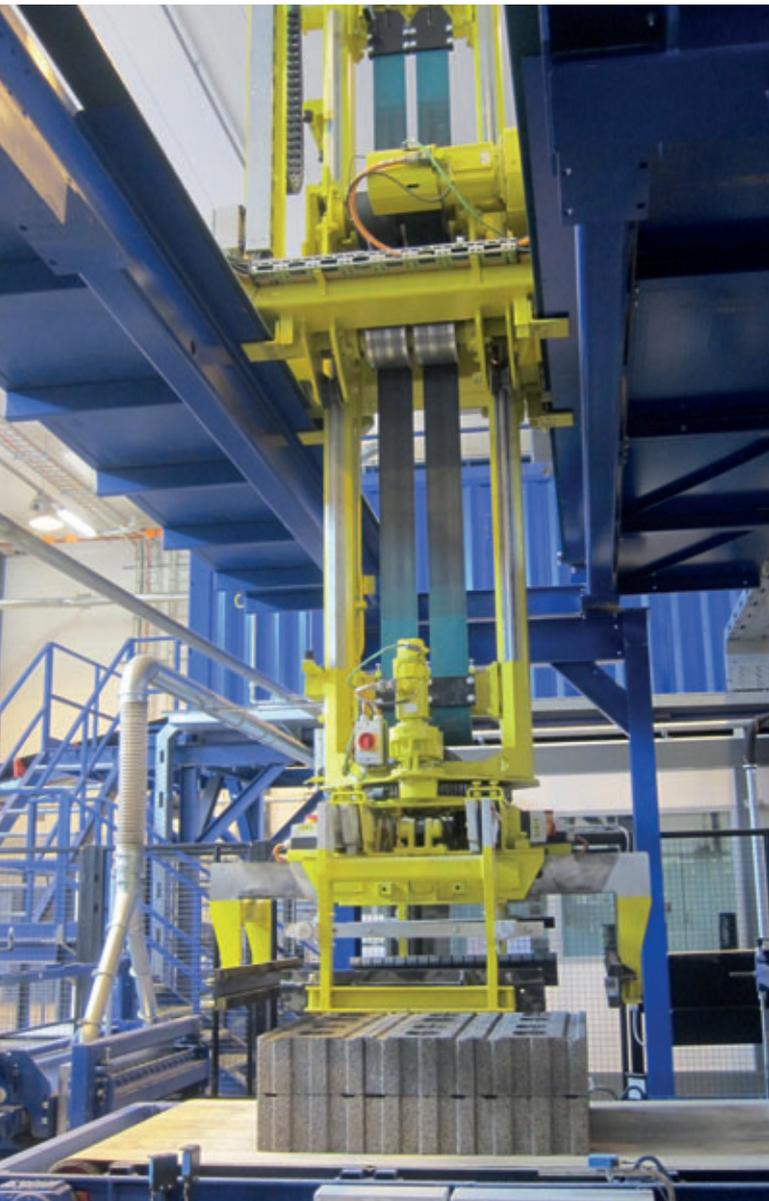
Die drehbar aufgehängte Greif- und Klammereinrichtung mit elektrisch angetriebener Servo-Vierseitenklammer
