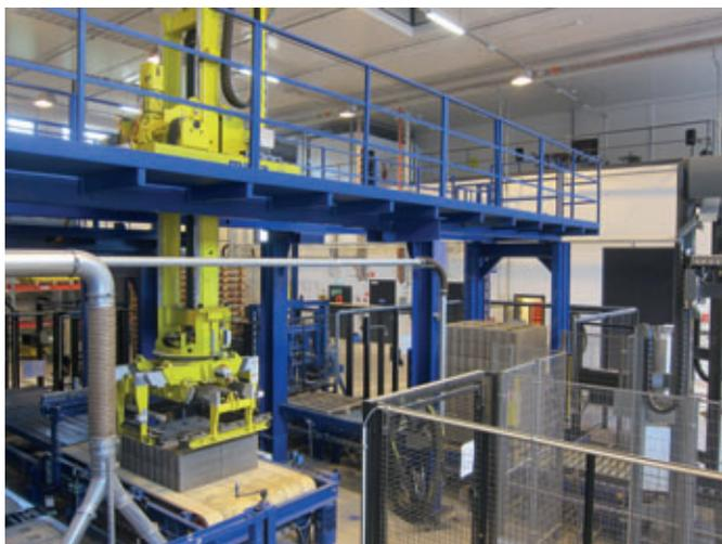
Jeweils zwei Steinlagen, die zuvor mit dem Lagendoppler erstellt wurden, nimmt der zweite Greifroboter und erstellt daraus Steinpakete auf der hinter liegenden Bahn.
