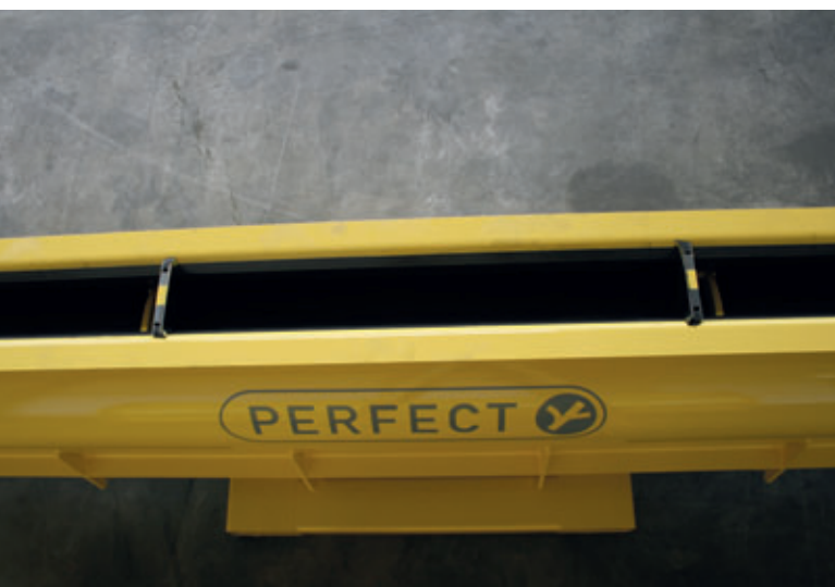
Individuell justierbare Seitenverschlüsse ermöglichen individuelle Baulängen in der Perfect Pipe Passrohrfertigung.
