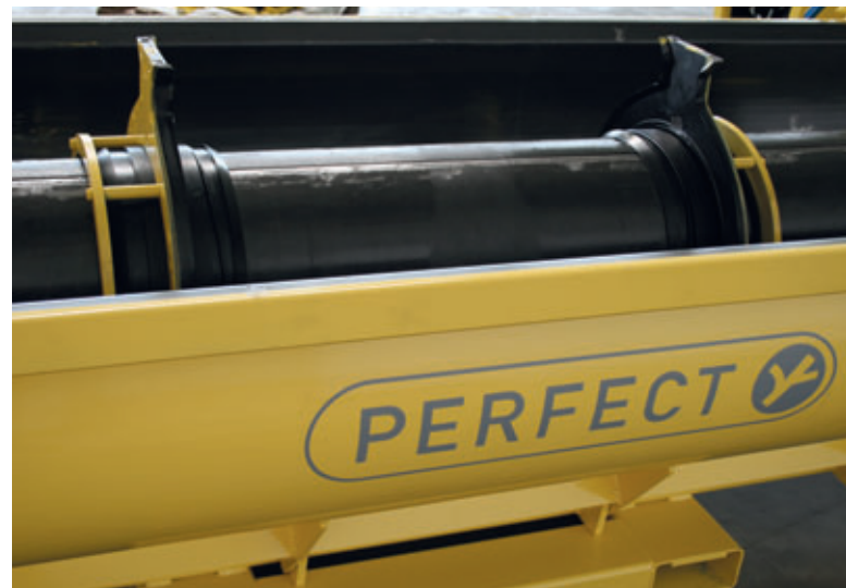
Einblick in eine Passrohrform mit frei justierbaren Seitenverschlüssen
