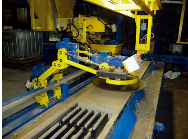
可选的抹平设备也可以在自动模式下运行
