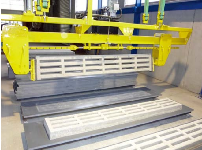
L-3 装配有液动压板的产品提升装置
