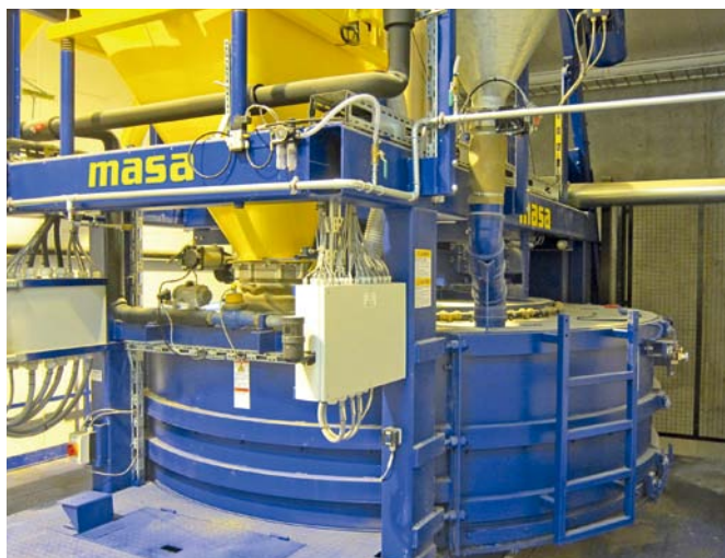
从 Masa 公司引进的 PH 3000/4500 水平强制式搅拌机
