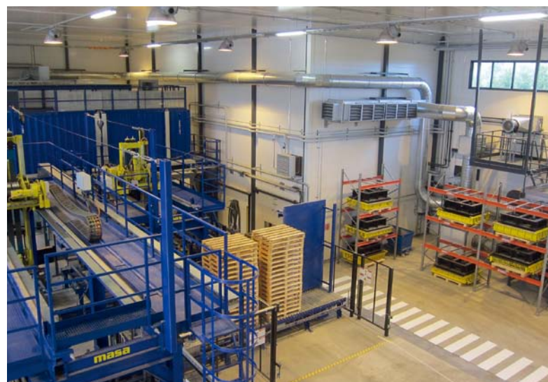
芬兰的冬季又冷又长。在此种情况下，为了能够持续生产，整个生产车间都内衬了阻燃的绝缘材料
