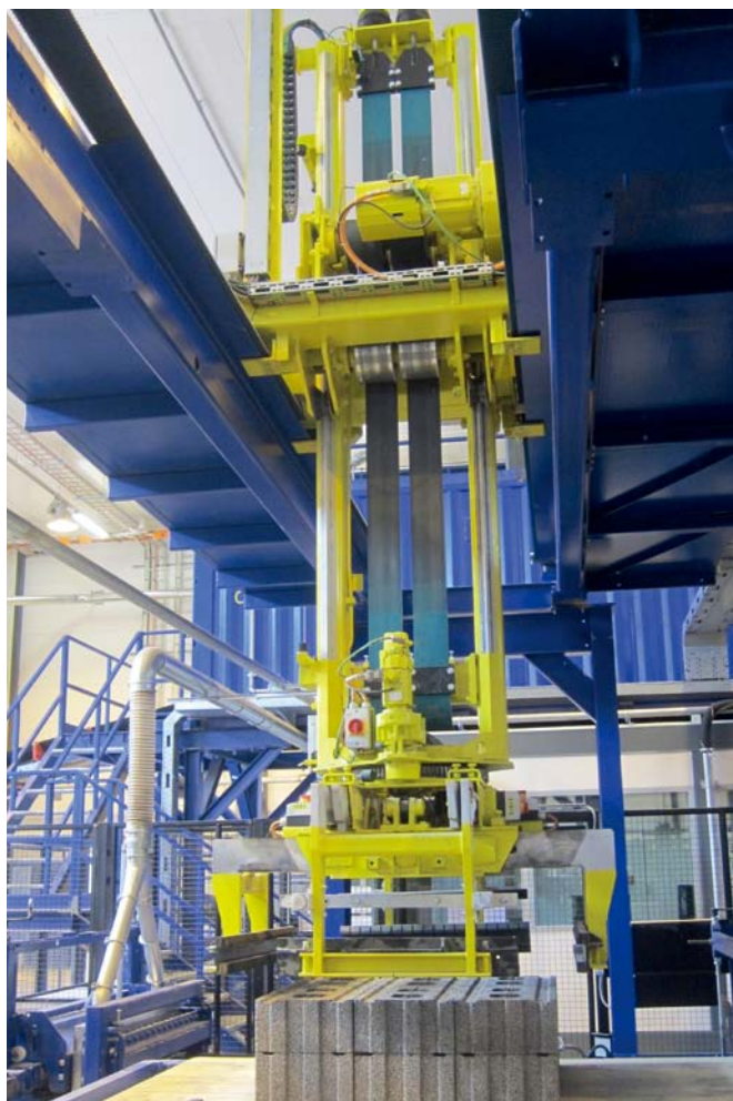
旋转的吊式抓取夹具设备在 4 侧都有电动夹具
