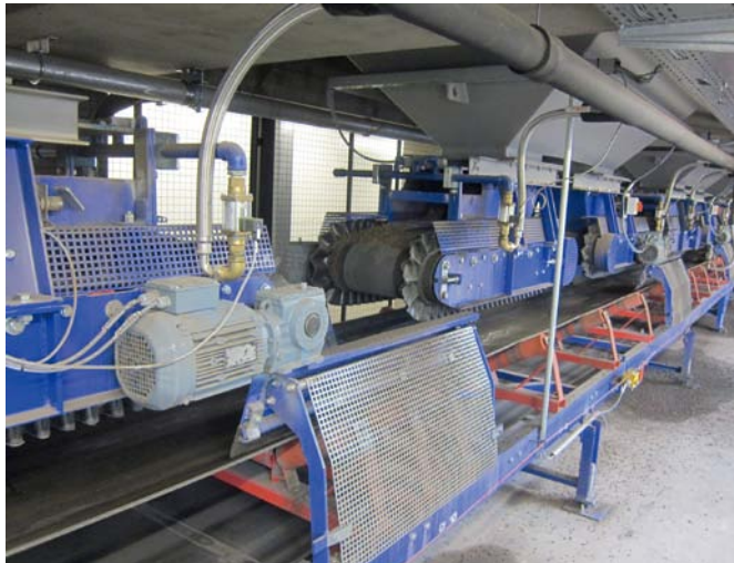
骨料仓有 2 个出料口。配比按容量计量。每个传送带上都有一个喷射装置，用来加湿原材料
