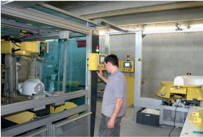
Вид на обрабатывающий станок для изготовления негативных форм каналов из пенополистирола
