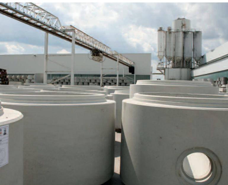
На БСУ Liebherr производится самоуплотняющийся бетон для колец с днищем Grafe-Perfect, который затем на автобетоносмесителе доставляется в производственный цех
