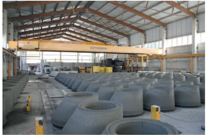
В задней части этого цеха, в котором в течение многих лет производятся бетонные кольца на установке Exact от компании Schlüsselbauer, разместился новый участок по изготовлению колец с дном Perfect
