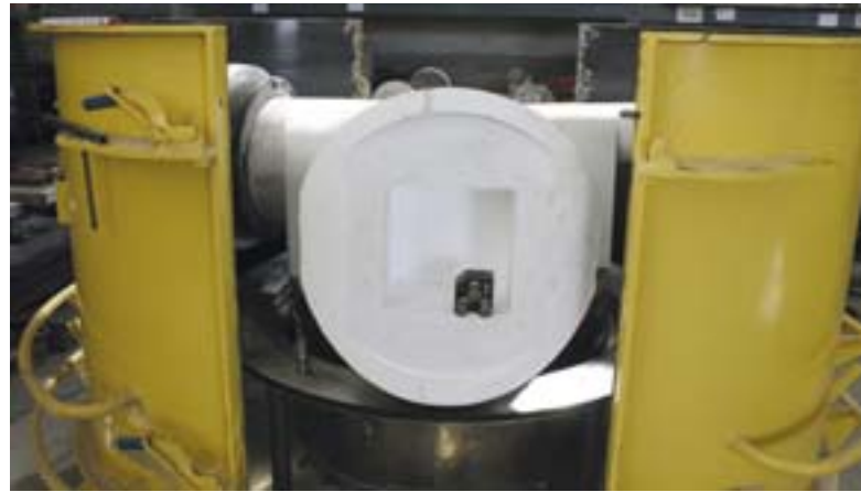
Sklejone wkładki styropianowe są mocowane w stalowej formie za pomocą magnesów i zabezpieczone przed przemieszczeniem.
