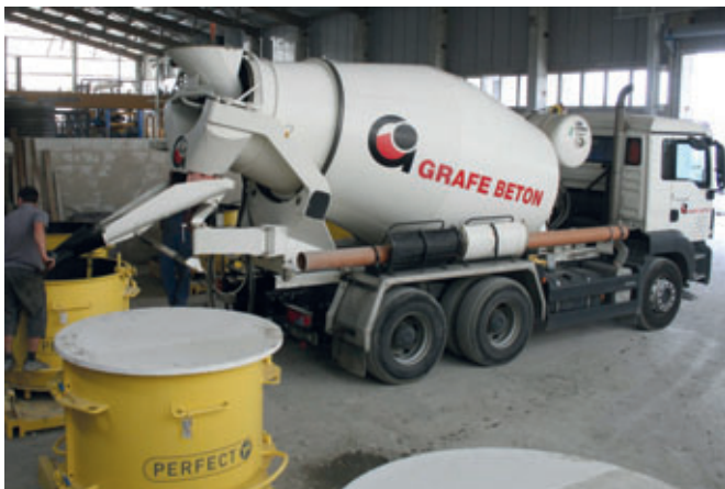
Un camion malaxeur de la flotte Grafe Beton transporte le béton jusqu'au site de production.
