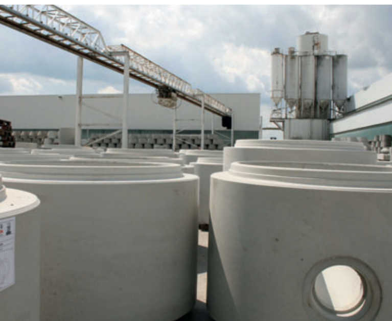
Die Betonzentrale mit den Liebherr-Mischern produziert den Selbstverdichtenden Beton für die Grafe-Perfect-Schachtunterteile, der dann mit dem Fahrnischer in die Produktionshalle gefahren wird.
