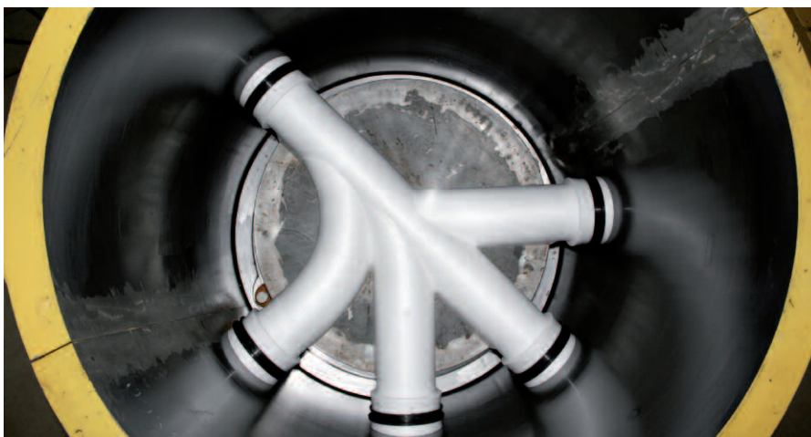
В монолитных кольцах с дном объединены несколько вводов. На фото – оснащенная форма для DN 800
