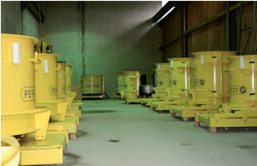
В общей сложности на заводе Rhomberg имеется 16 форм для заполнения самоуплотняющимся бетоном
