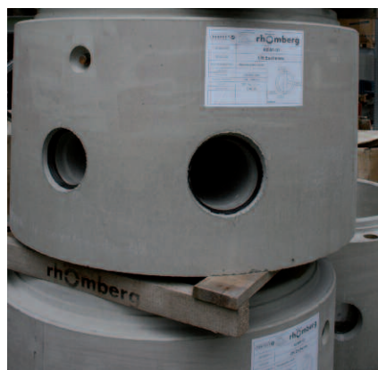
В зависимости от толщины стенок, грузоподъемные анкеры закладываются в бетон в стенках или на опорной поверхности колец
