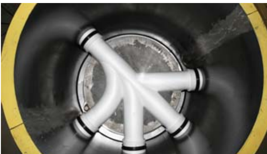
Także w przypadku średnic mniejszych niż DN1000 możliwe jest zastosowanie kilku dopływów – na zdjęciu przygotowana forma dla dennicy DN800.
