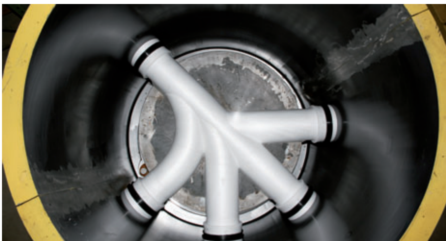
Plusieurs branchements d'entrée sont également réunis dans les fonds de regard < DN1000. Sur l'illustration, on peut voir un moule préparé pour un fond de regard DN800.
