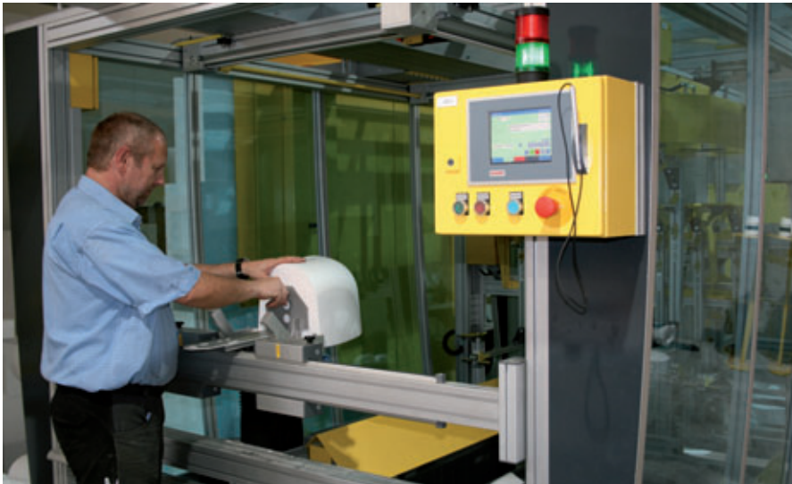
La manipulation du système de fabrication Perfect, qui fonctionne avec des matrices en polystyrène expansé, est relativement simple et ergonomique.
