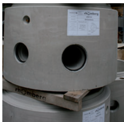
Selon l'épaisseur des parois du fond de regard, les ancrages de manutention sont coulés soit dans la paroi soit dans la surface d'appui des anneaux de regard.
