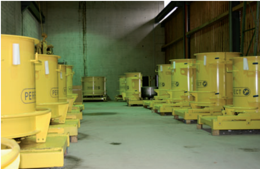
Au total, l'usine béton Rhomberg dispose de 16 moules pouvant être remplis de béton auto-plaçant.
