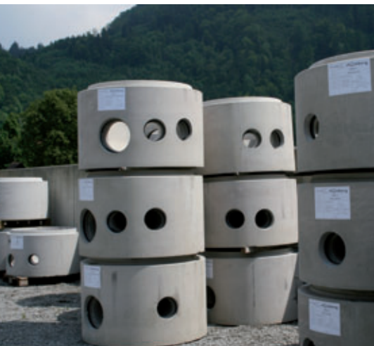
Rund zwei Monate nach Inbetriebnahme des Perfect Fertigungssystems werden zahlreiche Projekte mit den maßgefertigten Schachtunterteilen ausgeführt.
