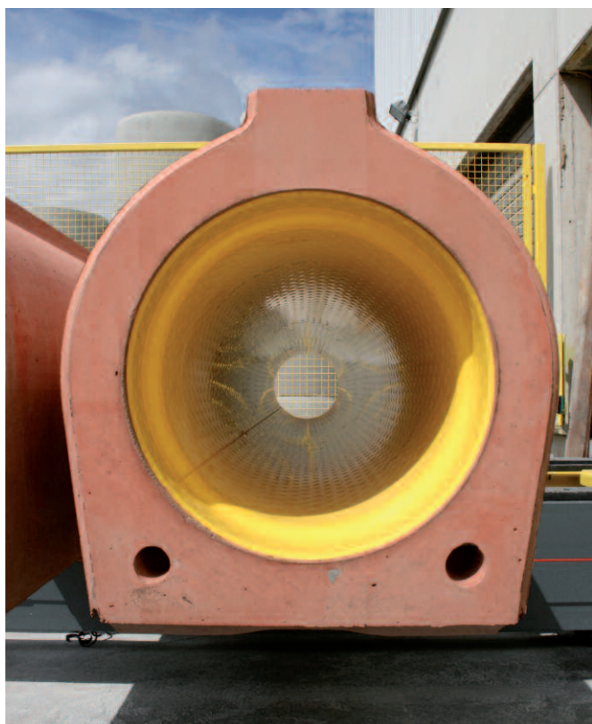
Трубы с плоским основанием и внутренней футеровкой облегчают не только монтаж на строительной площадке, но и придают стабильность всей линии трубопровода
