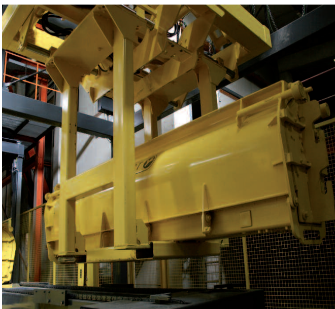
Автоматический захват транспортирует формы на пост выдержки. Форма с затвердевшим изделием опускается в установку для автоматизированного процесса распалубки
