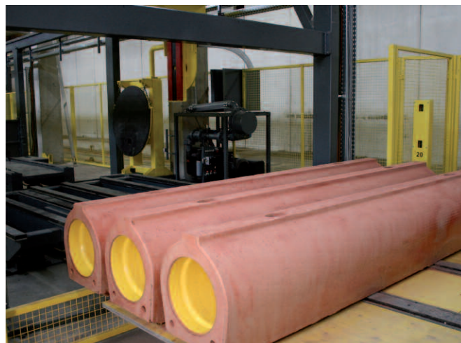
Полностью расформованные изделия после тестирования устанавливаются на ленточный конвейер и транспортируются из цеха на склад
