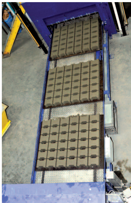
Цепной конвейер на «мокрой» стороне
