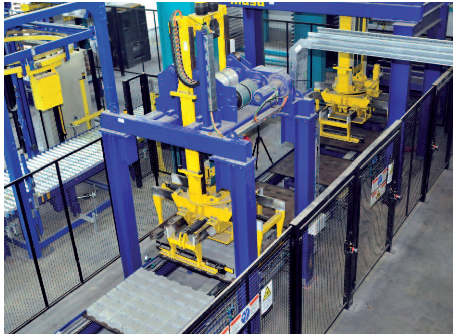
Обратный транспортер с четырехсторонним центрирующим устройством и пакетиروщик
