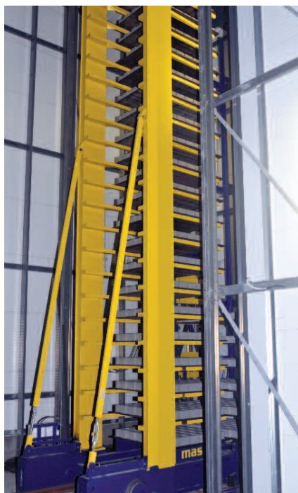
Мобильный накопитель между платформой и опускающим устройством
