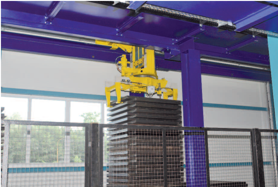
Захват для укладки и забора поддонов на складе поддонов
