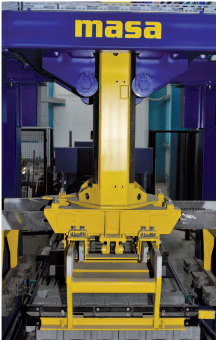
Детальный вид четырехстороннего центрирующего устройства с сервоприводами
