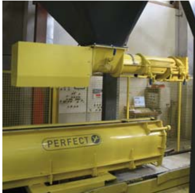
Beton samozagęszczalny dostarczany jest przy pomocy silosu pośredniego.
