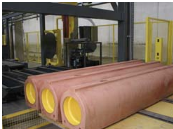
Rozformowane wyroby sprawdzane są podciśnieniowo na szczelność i przygotowane do wywiezienia z hali produkcyjnej.
