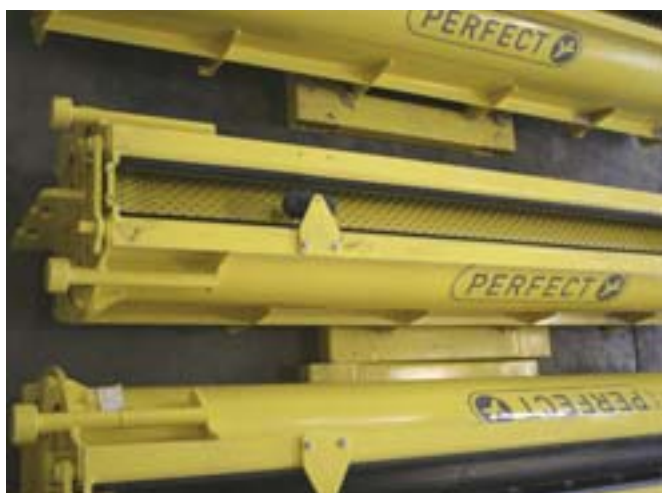
Poziome formy z wykładziną (lub bez) są przygotowane do automatycznego zalewania betonem.
