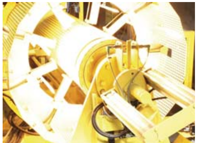
Termoplastyczne kształtowanie końców wykładziny dostosowuje jej kształt dokładnie do kielicha rury.
