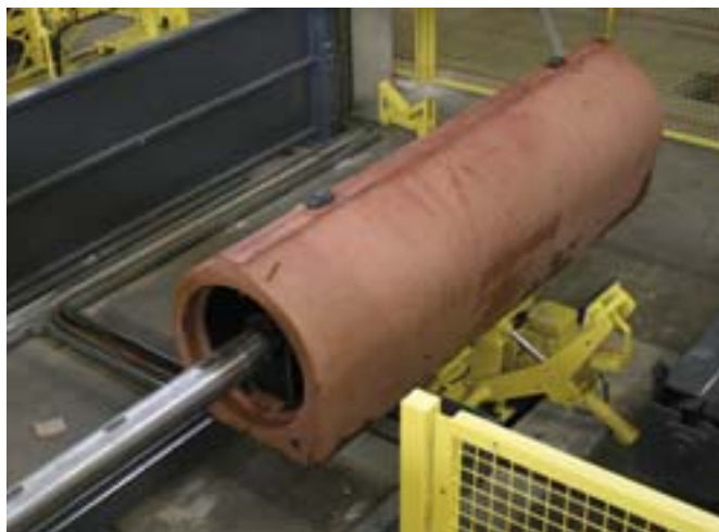
Znajdujący się jeszcze w wyrobie rdzeń wyposażony w nowego typu mechanizm kurczenia jest automatycznie wyjmowany.
