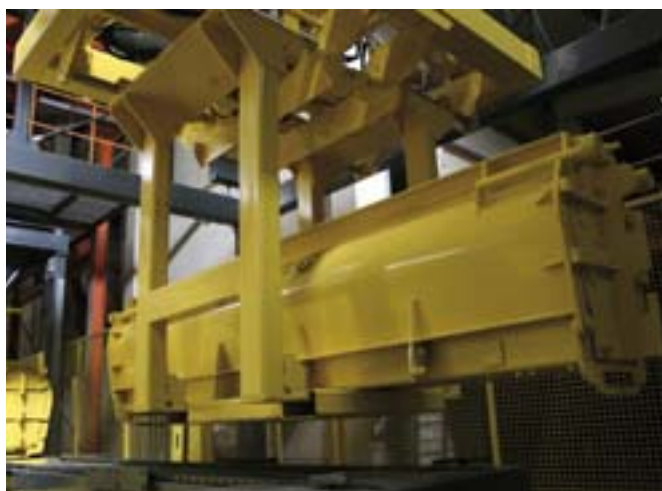
Robot stawia napełnione betonem formy na przewidziane dla nich miejsce. Forma z dojrzałym wyrobem przenoszona jest w miejsce automatycznego rozformowania.
