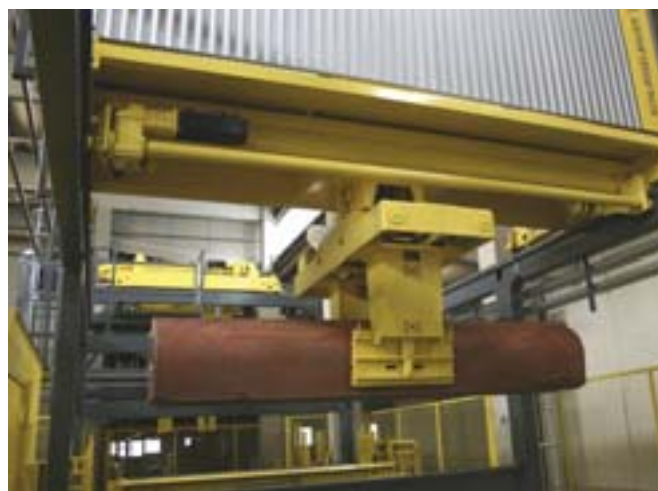
Po automatycznym otwarciu form inny robot przejmuje wyrób.
