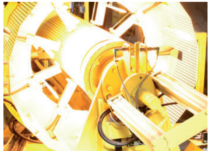
Mediante un processo di rimodellamento le estremità dei liner vengono forgiate a seconda del bordo del manicotto del tubo.
