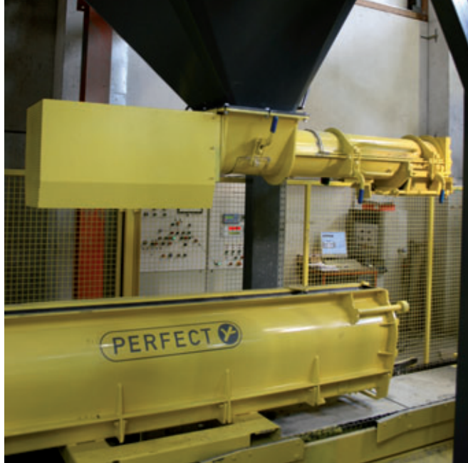
Tramite un imbuto la stazione di betonaggio viene continuamente approvvigionata con SCC dall'impianto di miscelazione.
