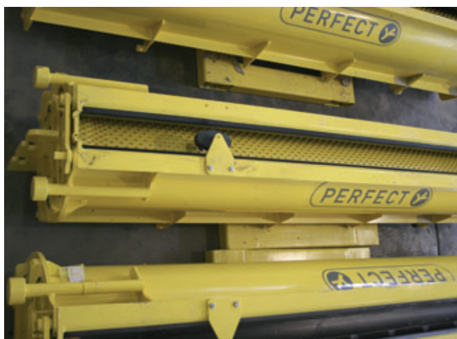
Le forme ideate per essere collocate in orizzontale sono armate con o senza liner, pronte per il betonaggio automatico.
