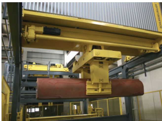
Dopo l'apertura automatica delle forme un ulteriore robot prende in consegna il prodotto.
