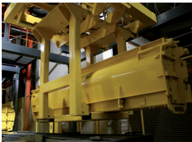
Un robot prende in consegna la forma riempita di calcestruzzo e la depone nella zona adibita all'indurimento. In alternativa viene afferrata una forma con il prodotto già indurito e deposta nell'impianto per la disarmatura automatica.
