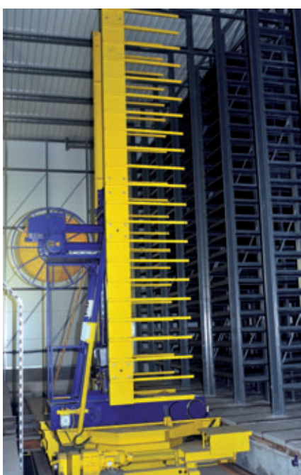
Piattaforma mobile e impianto di scaffalature
