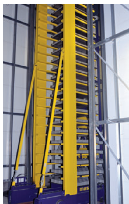
Pre-sollevatore come accumulo mobile tra la piattaforma mobile e il discensore
