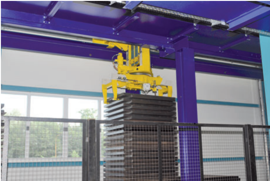
Pinza per pacchi di lamiera per depositare e prelevare a magazzino le lamiere di produzione nell'accumulo per lamiere
