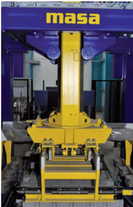
Détail d'un centrage quatre côtés avec servomoteurs
