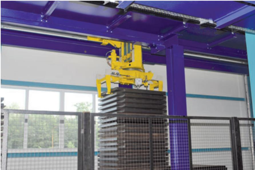
Pince à paquets de tôles pour stockage et prélèvement de tôles de production dans le tampon
