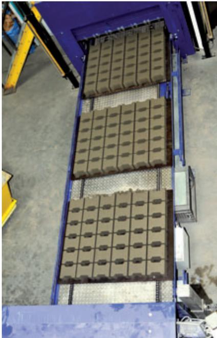
Transport côté humide avec système de convoyeur à chaînes
