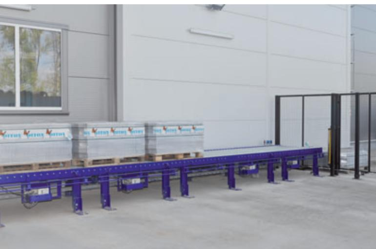
Transport des paquets jusqu'au poste de prélèvement des piles
