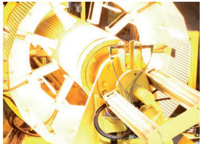
Au cours d'un processus de façonnage thermoplastique, les extrémités de la chemise sont façonnées en fonction de l'emboîtement.
