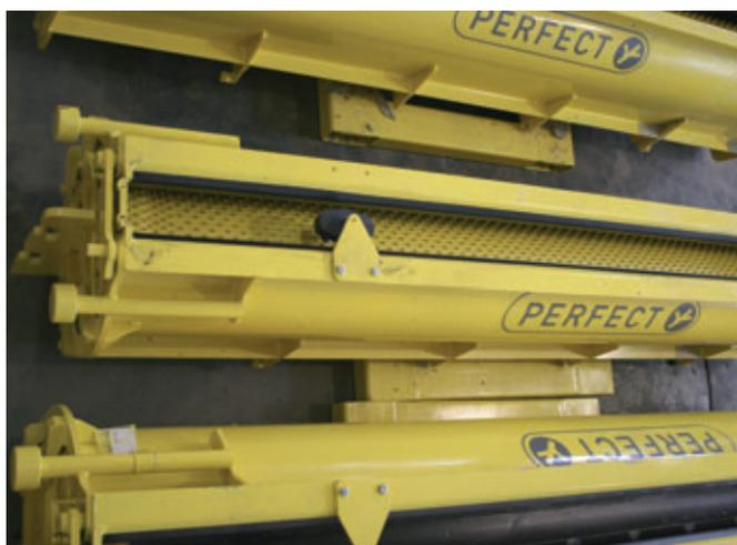
Des moules conçus pour la production en mode horizontal sont prêts, avec ou sans chemise, pour le processus de coulage entièrement automatisé.
