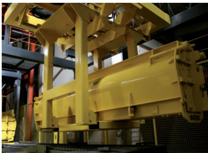
Un robot s'occupe de la maintenance des moules remplis et les dépose sur une plateforme à part afin de laisser le temps au mélange de durcir. Tandis qu'un autre moule, avec un produit béton déjà durci, est transféré pour le décoffrage automatique.
