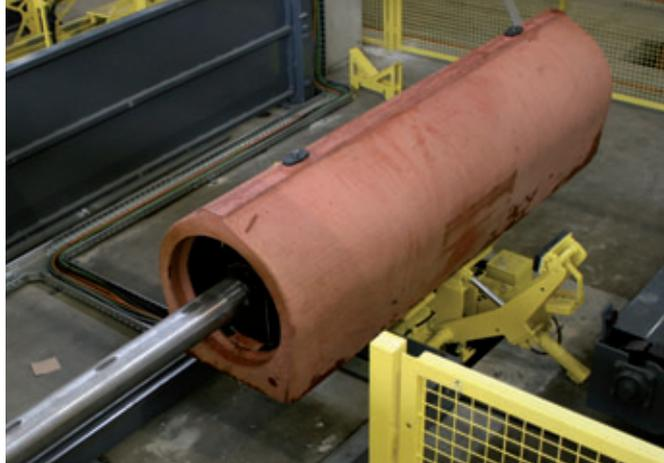
*Le noyau en acier se trouvant à l'intérieur du tuyau (doté d'un mécanisme innovant d'ouverture) est retiré en automatique.*
