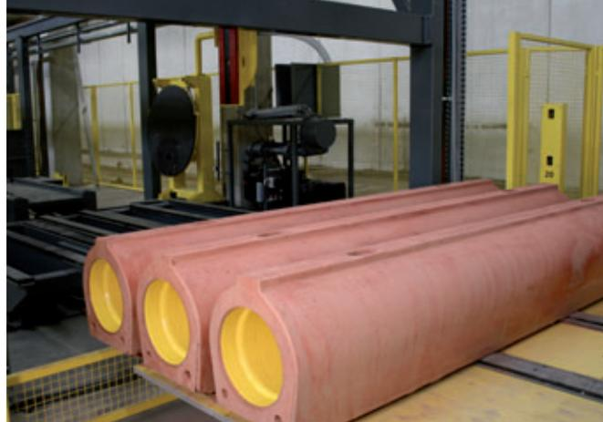
*Après avoir subi un contrôle sous vide précis, les produits décoffrés sont empilés en fonction de leur diamètre nominal et déposés sur un convoyeur. Ils quittent ensuite le hall de production afin d'être préparés pour le transport.*
