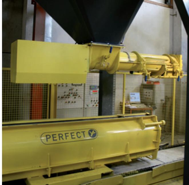
La station de coulage est alimentée continuellement en béton auto-plaçant provenant de la centrale à béton grâce à un entonnoir spécialement adapté.
