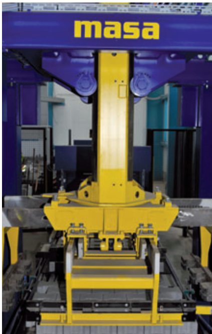
Detail einer Vierseitenzentrierung mit Servo-Antrieben
