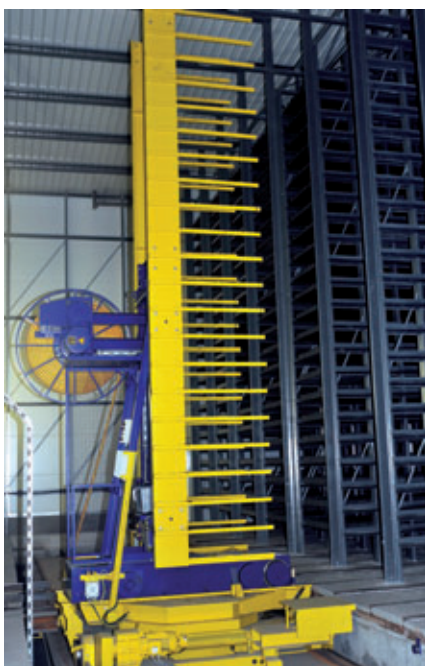
Schiebebühne und Regalanlage
