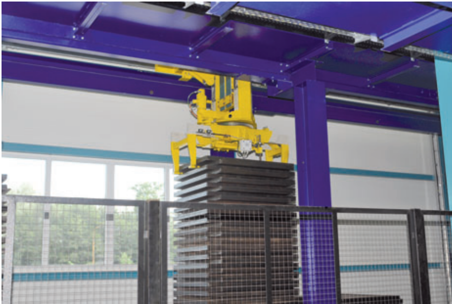
Blechpaketgreifer zum Ein- und Auslagern von Produktionsblechen in Blechpuffer
