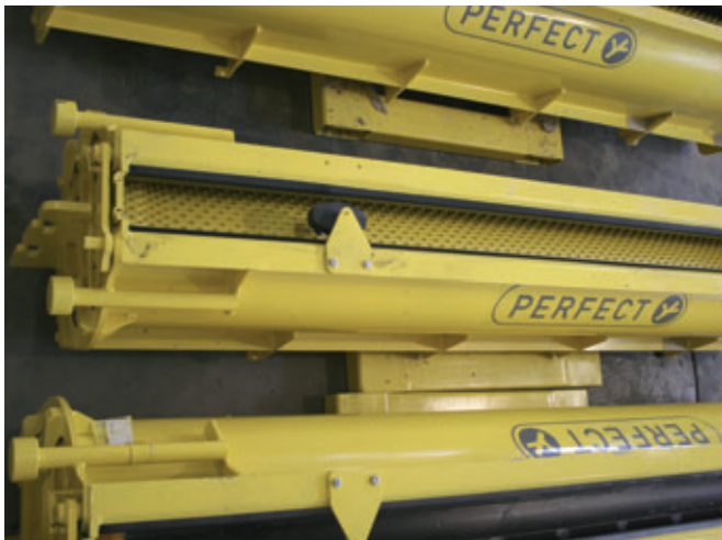
Die für Liegendfertigung konzipierten Formen stehen wahlweise mit oder ohne Liner bestückt bereit für den ebenfalls automatisierten Betoniervorgang.
