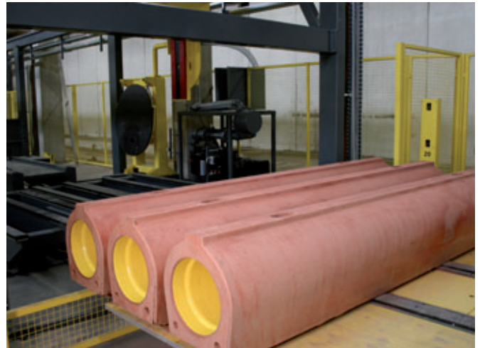
Die entschlachten Produkte werden nach einer In-Line-Vakuum-Prüfung entsprechend der Nennweite in Paketen auf das Austrageband gestellt und zum Abtransport aus der Halle gefahren.
