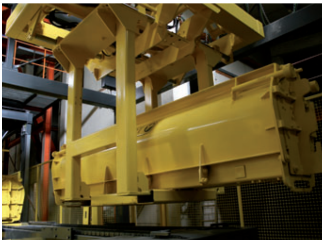
Ein Roboter übernimmt die befüllte Form und stellt sie auf dem vorgesehenen Aushärteplatz ab. Wechselweise wird eine Form mit bereits erhärtetem Produkt aufgenommen und zum automatischen Entschalen in der Anlage abgesetzt.
