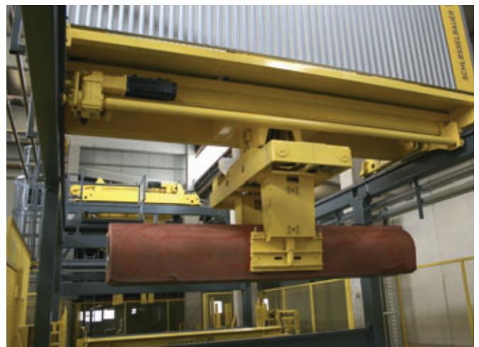
Nach dem automatischen Öffnen der Formen übernimmt ein weiterer Roboter das Produkt.
