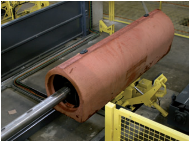
Der noch im Rohr befindliche innenliegende Stahlkern – mit einem ebenfalls neu entwickelten Spreiz-Mechanismus versehen – wird nun automatisch ausgefahren.
