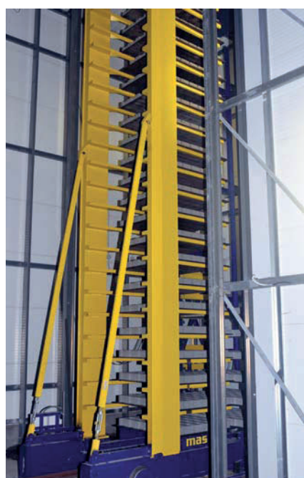
位于传送台和降落机之间的移动缓冲架，用来进行预提升
