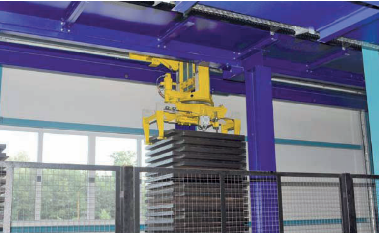
托盘包搬运钳，用于将托盘产品运至或远离托盘存储架
