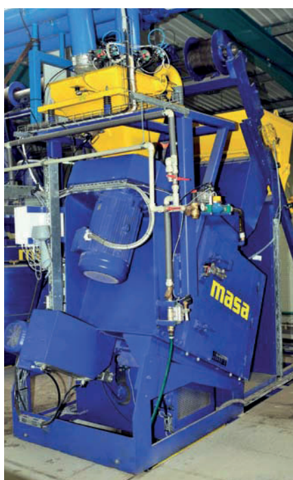
缠绕器型号为 S350/500 的护面混凝土搅拌机
