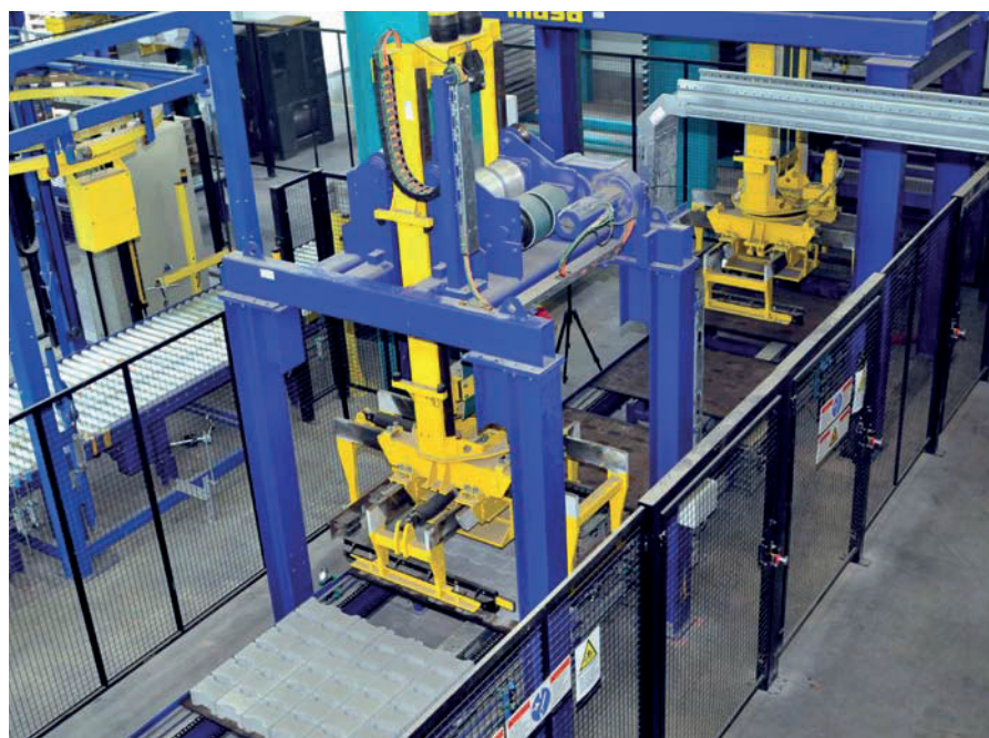
带有四面定心器的返送装置及封包器
