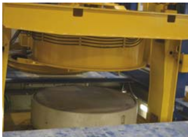
Szybkie rozformowanie świeżych wyrobów bezpośrednio w maszynie zapewnia skrócenie cyklu produkcyjnego.
