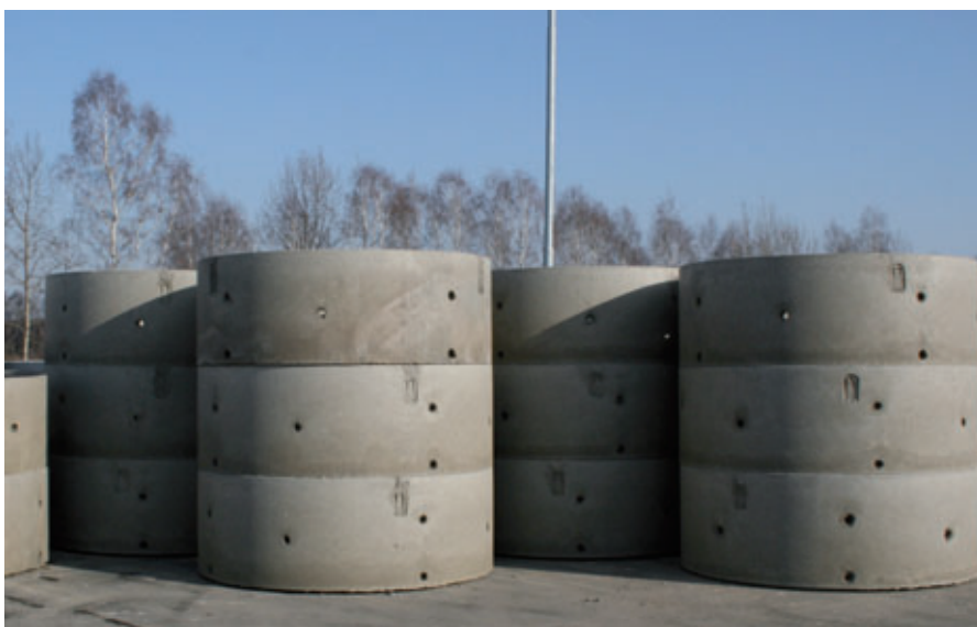
Anelli di drenaggio nel magazzino esterno
