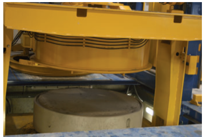
Uscita degli anelli dalla macchina in brevi tempi ciclo
