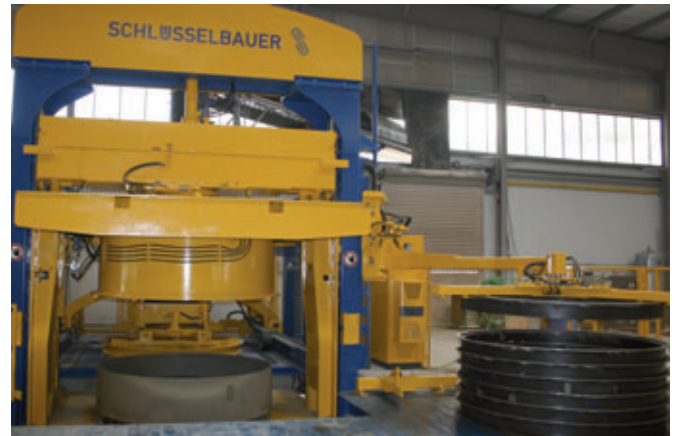
L'impianto di produzione Magic2500 per la produzione di pezzi finiti con un diametro esterno di fino a 2.700 mm
