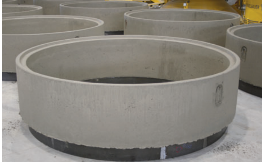
Anelli per pozzetti dal diametro nominale DN1500 nella zona di indurimento
