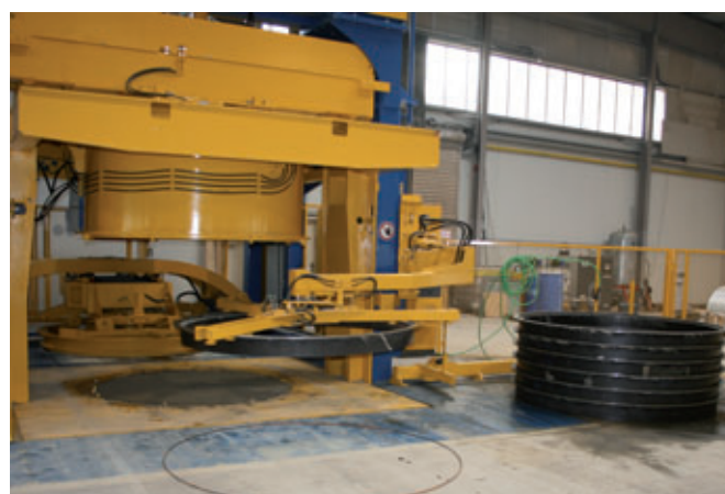
Il dispositivo per l'inserimento automatico dei manicotti rappresenta un elemento essenziale del funzionamento a un operatore di questo impianto
