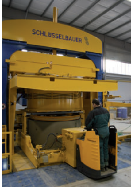
Per il trasporto dei prodotti ci si avvale di un veicolo di trasporto elettrico dotato di manipolatore di anelli di supporto
