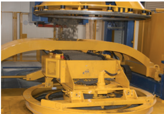
Il sistema di alimentazione di calcestruzzo della Magic2500 è stato interamente ricostruito; l'immagine mostra la rapida introduzione del calcestruzzo nella macchina
