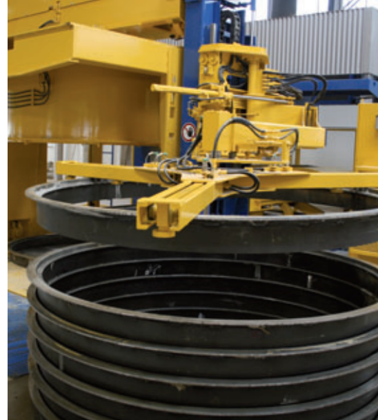
Un'innovazione nella manipolazione degli anelli di supporto: un manipolatore esegue la complessa operazione di posizionamento degli anelli di supporto
