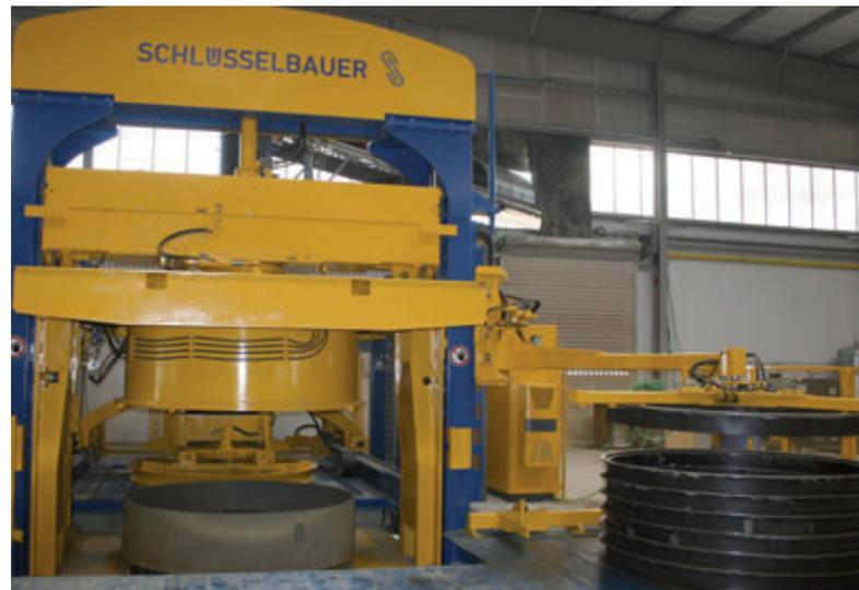
*L'installation de production Magic2500 pour la fabrication d'éléments préfabriqués d'un diamètre extérieur jusqu'à 2.700 mm*
