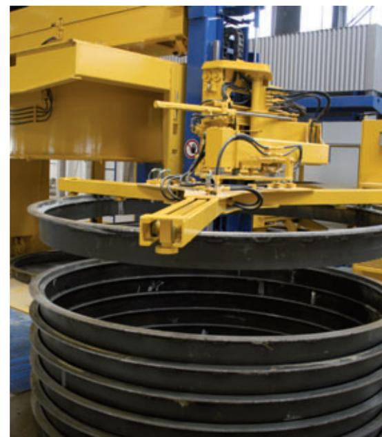
*Une innovation en matière de manipulation des coiffes – un manipulateur se charge du processus laborieux de mise en place des coiffes*
