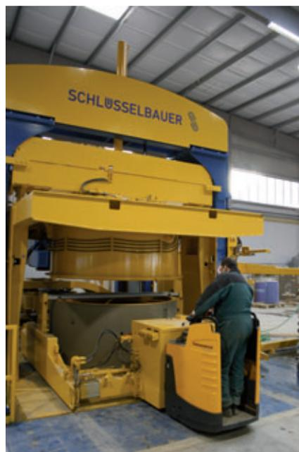
*Le manipulateur de coiffes permet à l'utilisateur de placer sans effort et sans l'aide d'un second travailleur les coiffes sur le produit fraîchement sorti de la machine*
