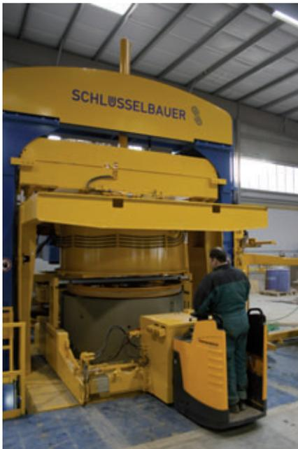
*Un chariot électrique équipé d'un manipulateur de coiffes assure la sortie des produits*
