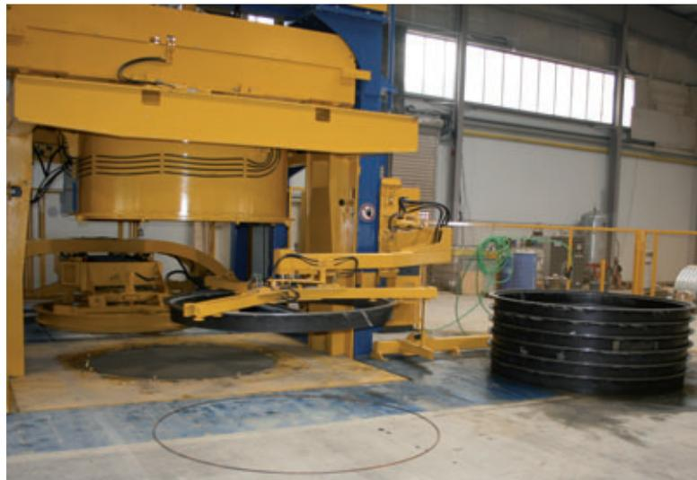
*Le dispositif automatique d'introduction des embases constitue un élément important pour la conduite de l'installation par un homme seul*
