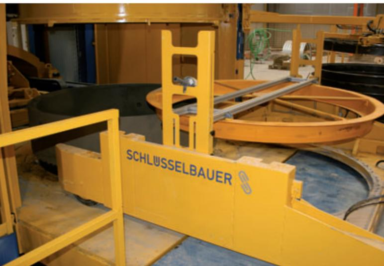
*Des processus automatisés permettent d'assurer la production sur l'ensemble de l'installation de production avec un seul homme ; seul le placement de l'armature s'effectue manuellement*
