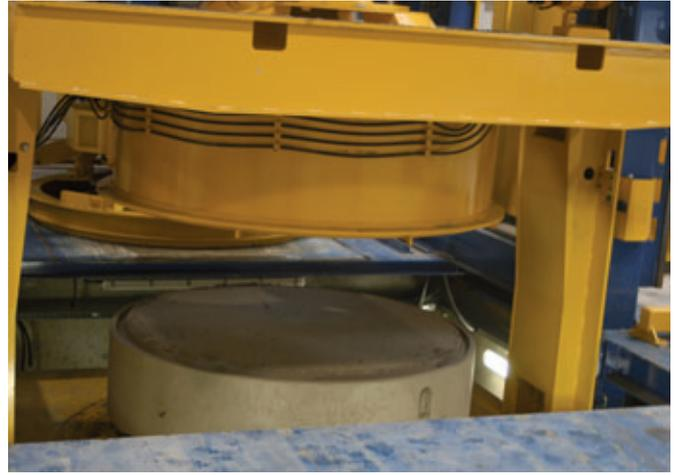
*Sortie des éléments de la machine, à bonne cadence*
