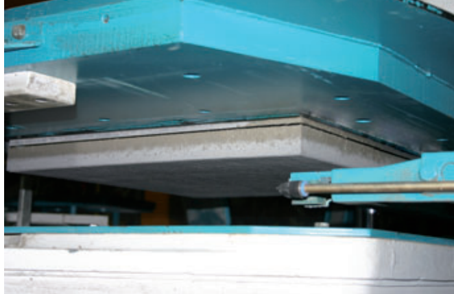
Figure 4 : éjecteur avec plaque à vide d'air
