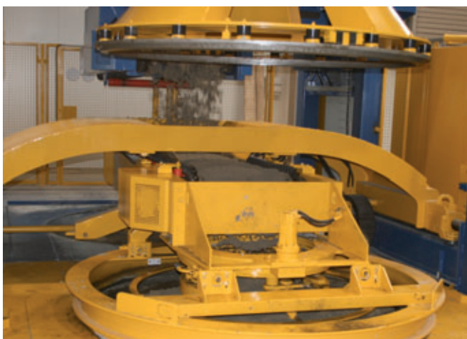
Die gesamte Betonversorgung der Magic2500 wurde neu errichtet, im Bild die rasche Einbringung des Betons in der Maschine
