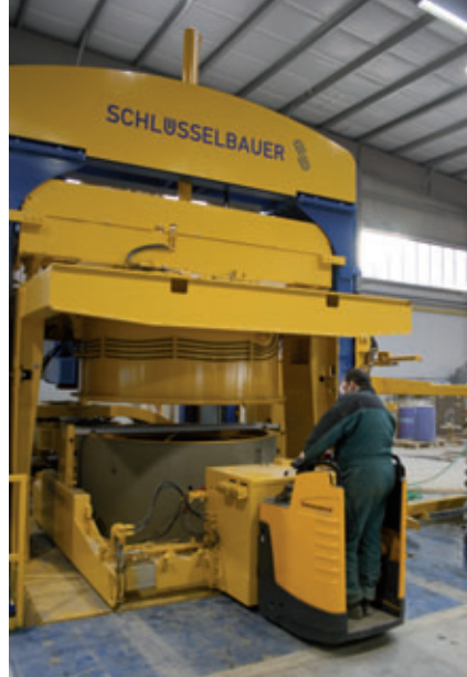
Der Stützringmanipulator erlaubt es dem Bediener, ohne Hilfestellung durch einen zweiten Arbeiter die Stützringe ohne Anstrengung am frischen Produkt zu platzieren
