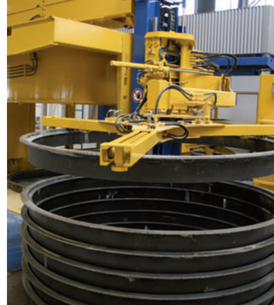
Die automatische Muffeneinlegevorrichtung stellt ein wesentliches Element der Ein-Mann-Bedienung dieser Anlage dar
