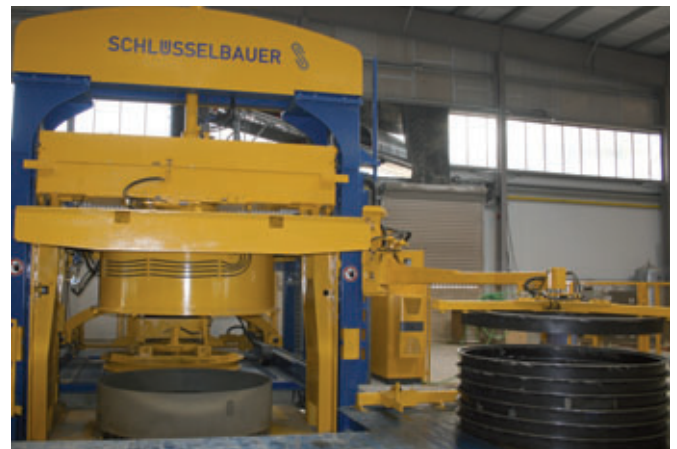
Die Produktionsanlage Magic2500 für die Herstellung von Fertigteilen mit einem Außendurchmesser von bis zu 2.700 mm
