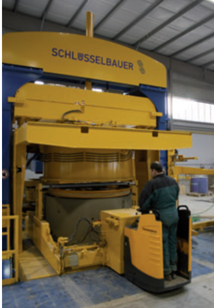
Für den Abtransport der Produkte wird ein elektrischer Abfahrwagen mit Stützringmanipulator eingesetzt
