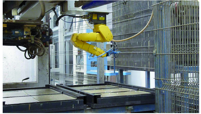
Устройство подачи шариков сбрасывает маленькие пластиковые шарики в только что залитую бетонную смесь
