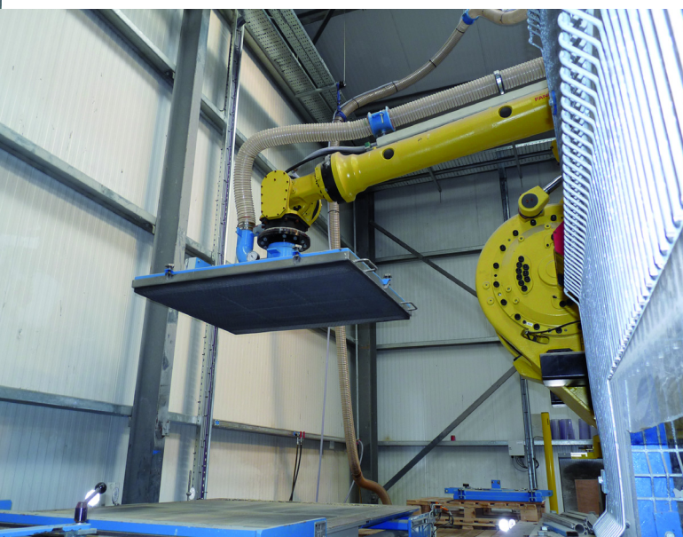
Робот снимает продукцию с помощью вакуумного захвата
