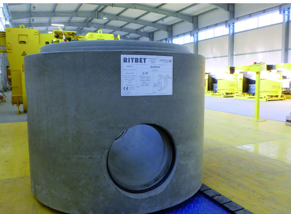
Монолитные кольца с дном перемещаются из цеха на склад
