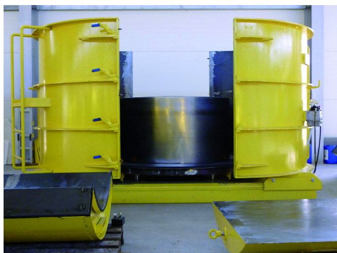
Формы больших размеров и элементы, используемые для усиления стенок
