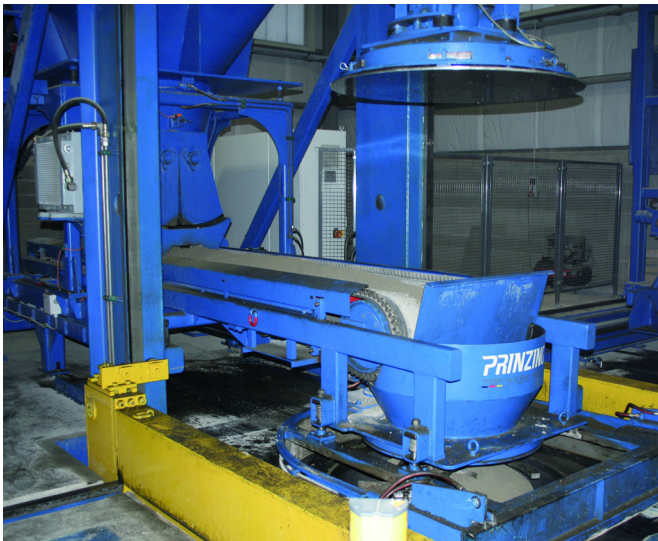
Шибберные задвижки дозатора гарантируют оптимальное заполнение формы бетоном
