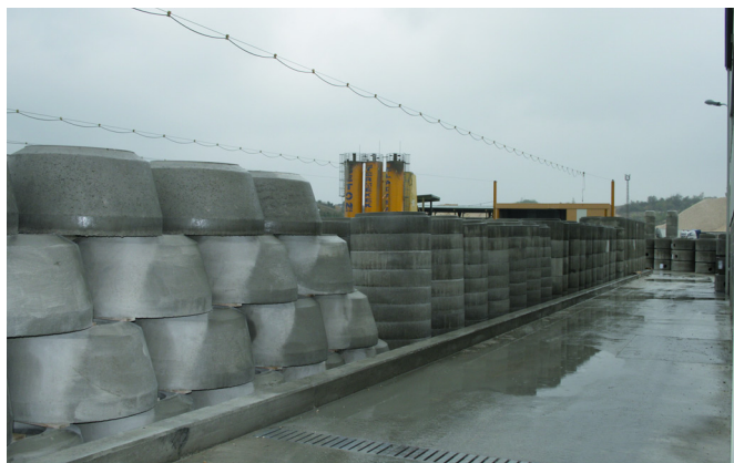
Компания Dolomit наладила производство индивидуальных монолитных колец с днищем
