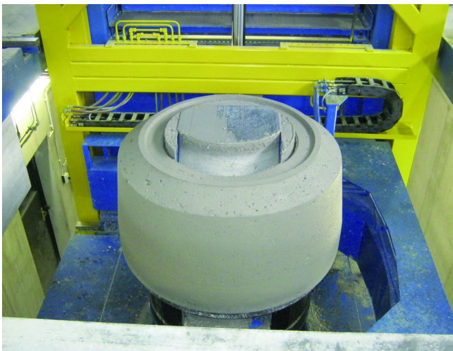
Конус колодца на установке Tornado. На установке Tornado компания Dolomit производит все детали для смотровых колодцев
