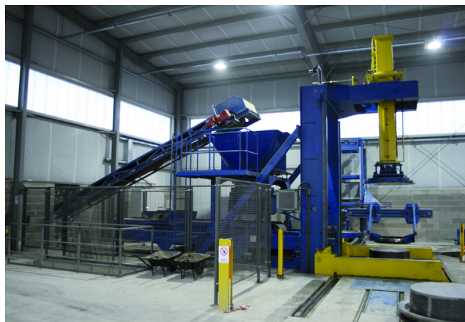
Полностью автоматическая установка для производства труб и колец Tornado от компании Prinzing
