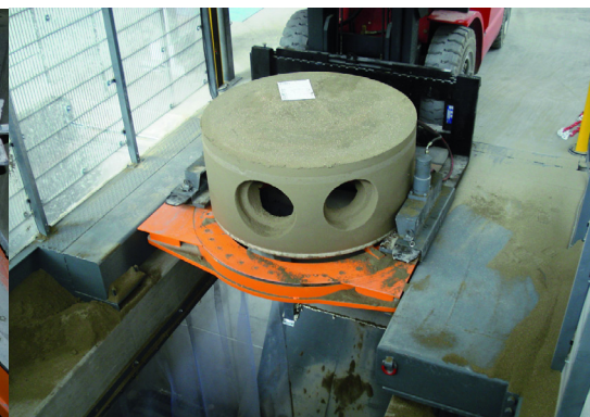
Отфрезерованное на установке Primuss монолитное кольцо с днищем
