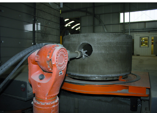
Если фрезеровка одного отверстия завершена, заготовка автоматически поворачивается для начала другой операции
