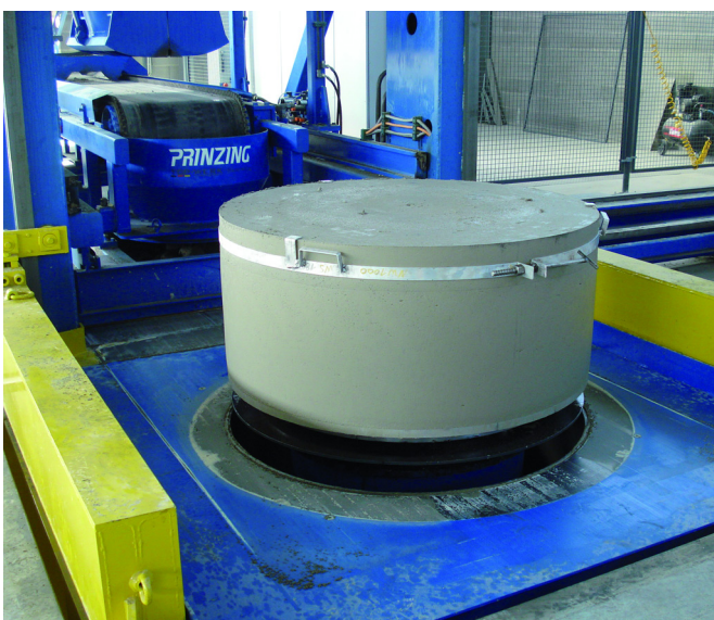
С заготовки монолитного кольца с дном снята опалубка. Спустя непродолжительное время выдержки заготовку можно отправлять на станцию фрезерования
