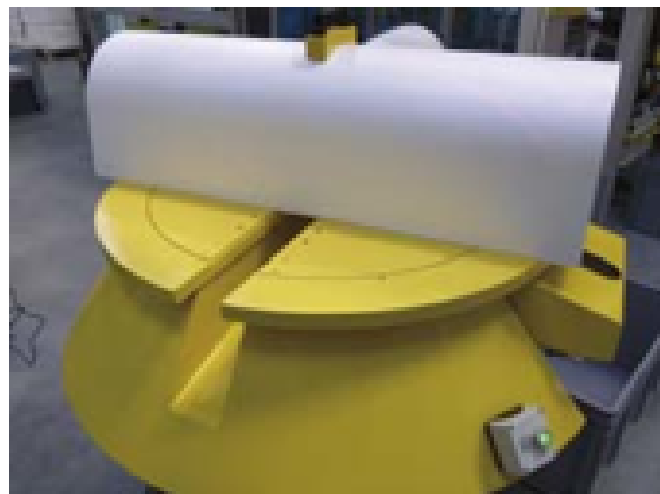
Wycinarka spocznika zapewnia wykonanie odpowiedniego spadku rynien kinety.
