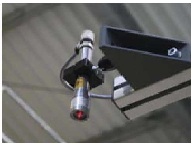
Bieżąca kontrola wykonania nadzorowana jest przez wskaźnik laserowy.
