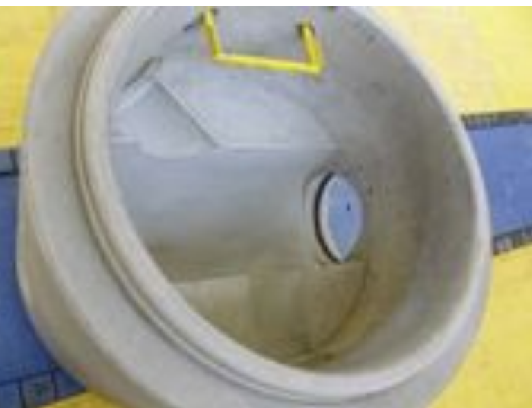
Podstawa studni z zamontowanym szczebłem złączowym gotowa do wysyłki.
