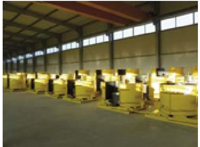
Ritbet ma obecnie do dyspozycji łącznie 33 formy Perfect na 3 różne średnice znamionowe i jedną specjalną formę na zbiorniki.
