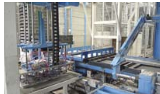
Rozformowane wyroby są przekładane na taśmociąg.
