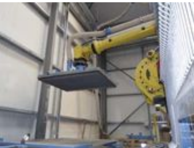
Robot podnosi wyroby za pomocą płyty ssącej.
