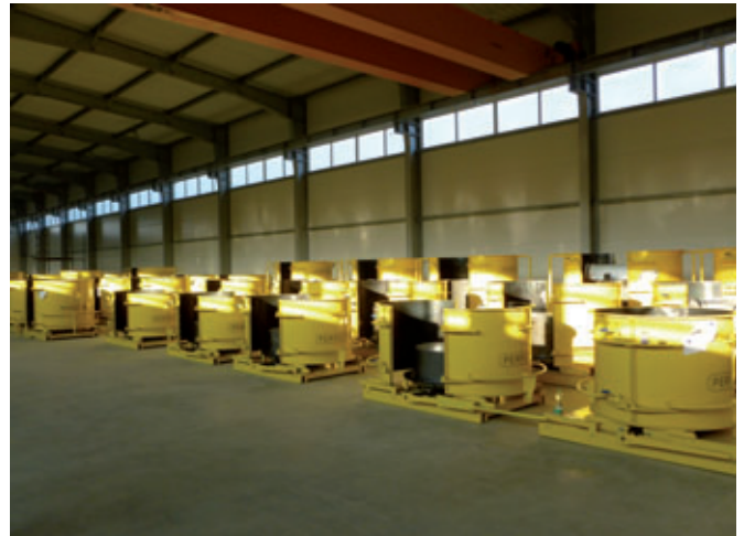
La Ritbet dispone a scopi della produzione di un totale di 33 stampi Perfect per pozzetti di tre diverse grandezze nominali e uno stampo speciale per recipienti
