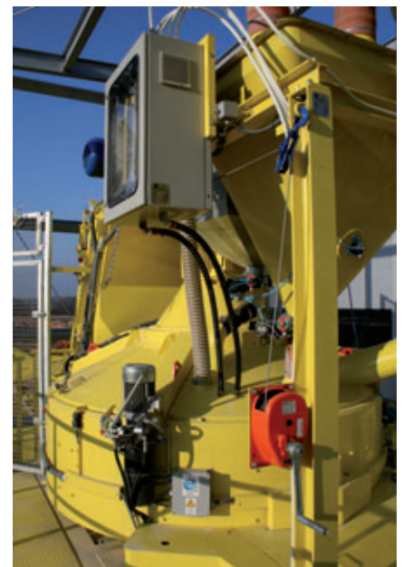
Il nuovo miscelatore di Eurostar ha un volume di 1,5 m 3
