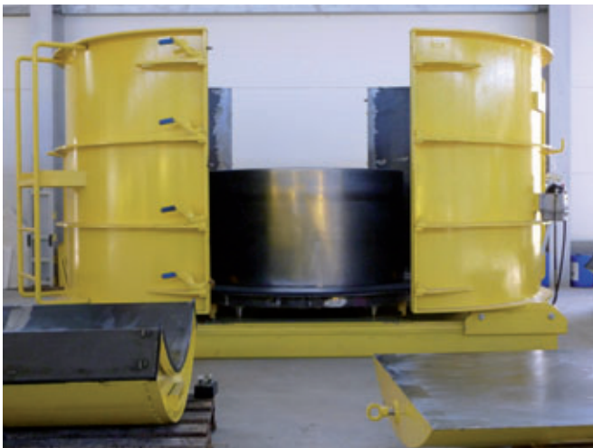
Stampi di grandi dimensioni ed elementi per la riduzione dello spessore delle pareti
