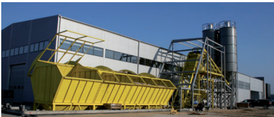
Il nuovo capannone della Ritbet per la produzione con la procedura Perfect. I rivestimenti dell'alloggiamento isolante per il funzionamento in inverno sul supporto di miscelazione erano ancora in corso di lavorazione poco dopo l'avvio della produzione
