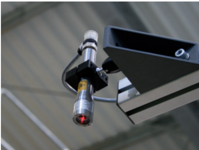
Controllo di qualità in-line mediante laser di posizione
