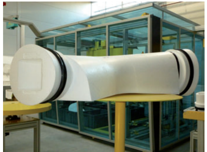
Guarnizioni premontati sui corpi dello stampo garantiscono in modo affidabile la perfetta tenuta dei collegamenti per tubi nell'elemento costruttivo finito
