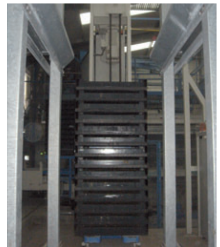
Piattaforma mobile con pila di pallet
