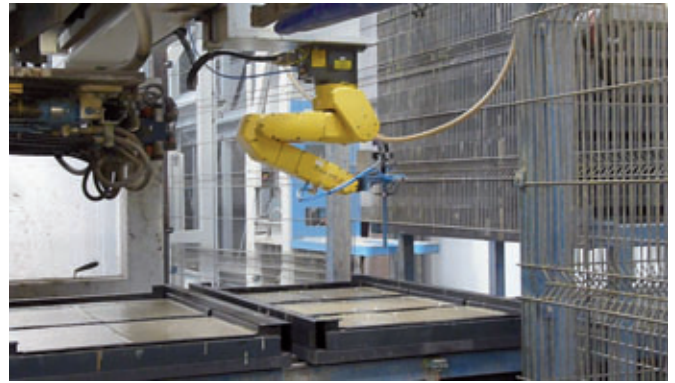
L'erogatore di palline getta piccole sfere di plastica sulla miscela di calcestruzzo appena riempita.
