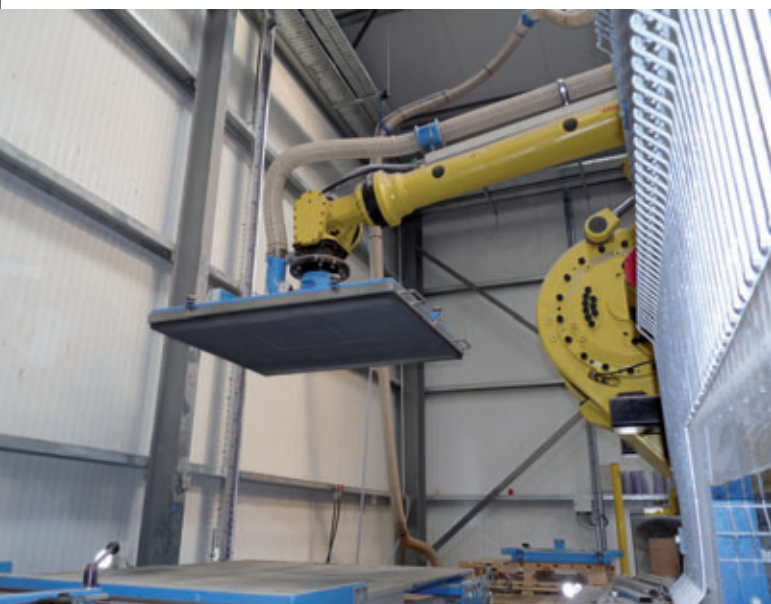
Il robot accoglie i prodotti tramite una piastra di aspirazione a vuoto.
