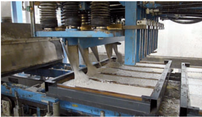
Il cuore dell'impianto è lo Smartdoser volumetrico
