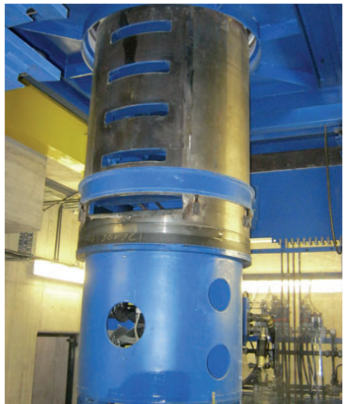
Noyau de moule d'anneaux de regard pour le vibration direct d'échelons d'accès
