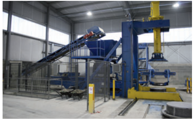
Machine à regards Tornado entièrement automatique de Prinzing
