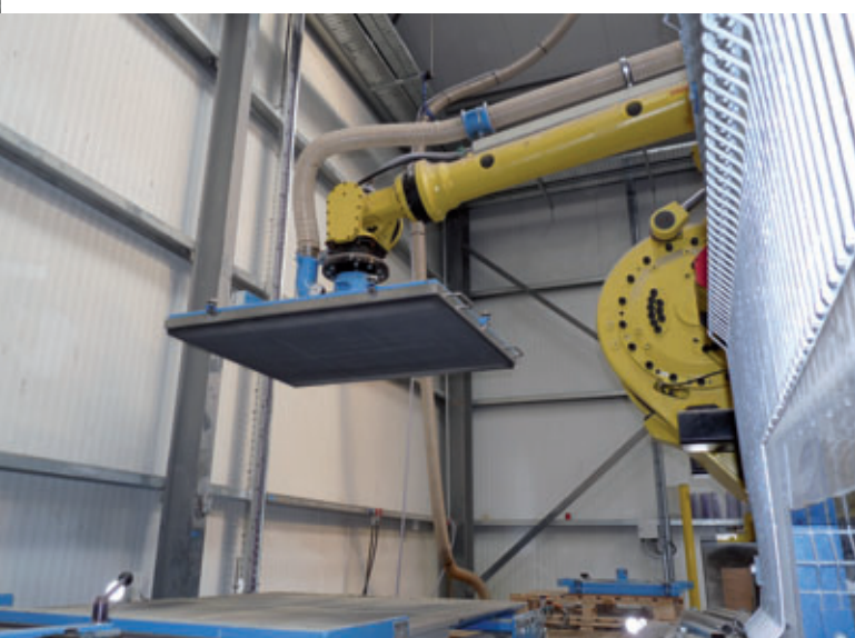
Le robot saisit les produits au moyen d'une plaque aspirante à vide.
