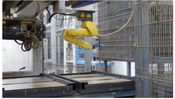
Le distributeur de billes lance les billes en plastique dans le mélange de béton fraîchement versé.
