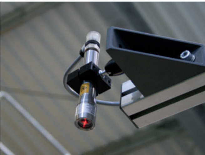
Contrôle en ligne de la qualité grâce aux lasers
