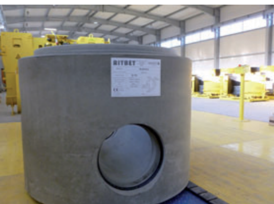
Des fiches techniques claires sont apposées sur les fonds de regard Perfect avant que ceux-ci quittent le bâtiment de production
