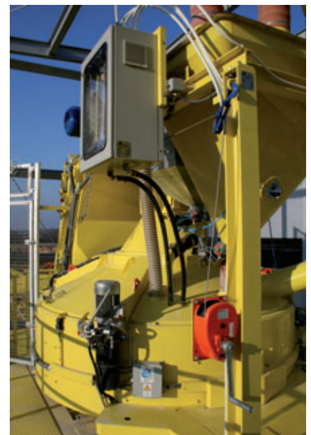
Le nouveau réservoir de la société Eurostar a une capacité de 1,5 m 3 .
