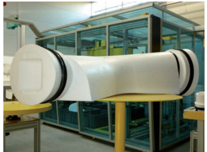
Les joints d'étanchéité déjà montés sur le moule garantissent de façon fiable des branchements tuyau étanches dans le produit fini
