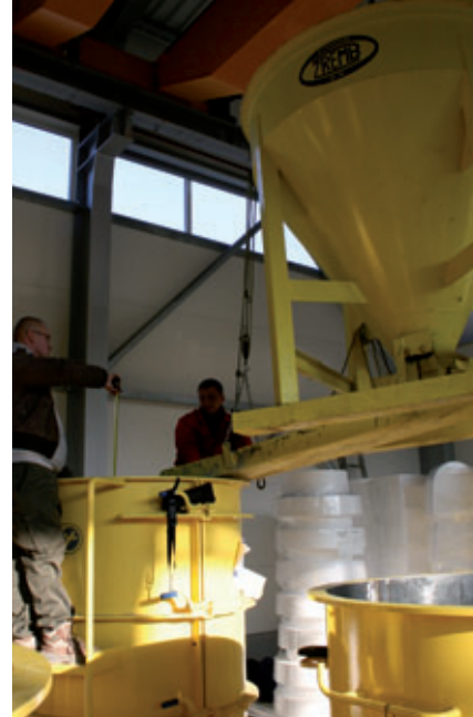
Le coulage s'effectue à l'aide d'une benne et d'un pont roulant
