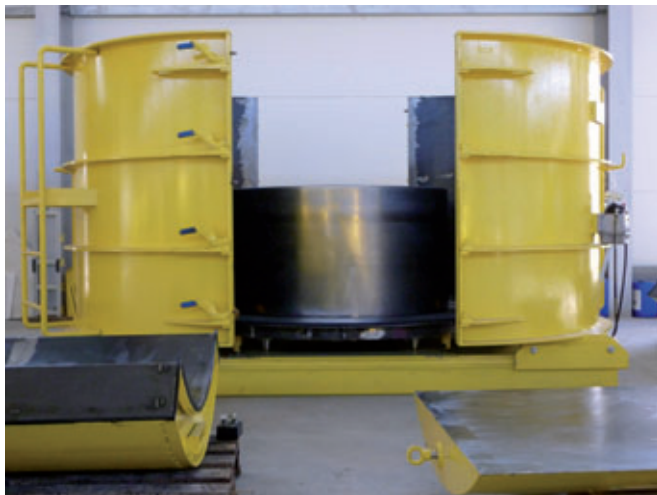
Moules de grandes dimensions et tôles de réduction de l'épaisseur des parois
