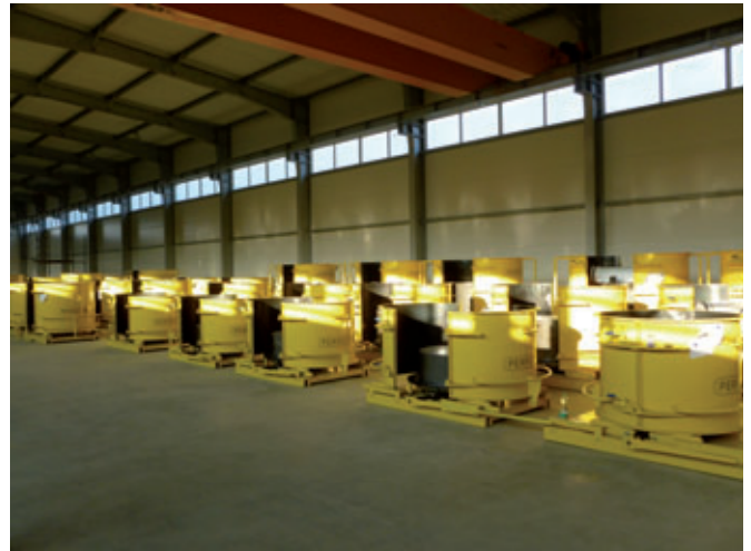
Au total Ritbet dispose de 33 moules Perfect permettant de fabriquer des regards dans trois dimensions nominales différentes et d'un moule spécial pour cuves
