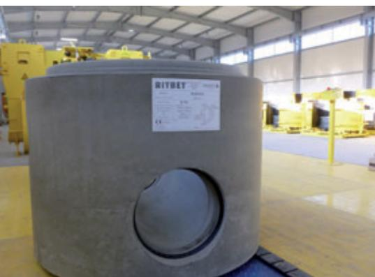
Mit übersichtlichen Produktdatenblättern bestückt verlassen die Perfect-Schachtunterteile die Fertigungshalle.
