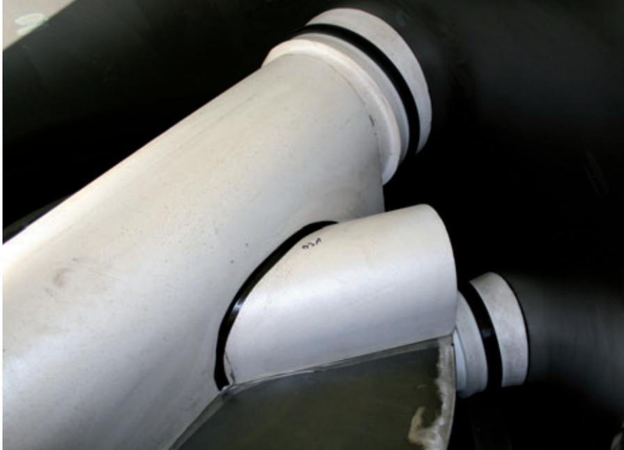
Fertig eingebautes Negativgerinne in der bereits geschlossenen Form, rechts ein für die Region typischer Absturz mit über dem Gerinne liegendem Rohranschluss
