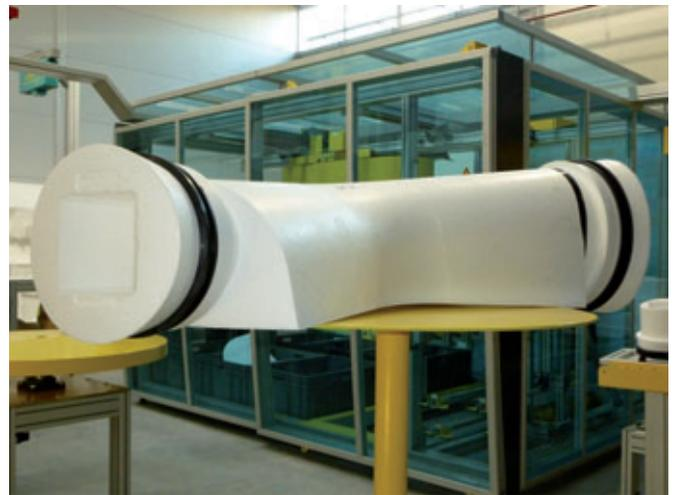
Bereits am Formkörper montierte Dichtungen sorgen zuverlässig für dichte Rohranschlüsse im fertigen Bauteil.
