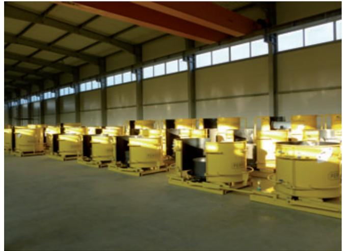
Insgesamt 33 Perfect-Formen für drei verschiedene Schachtnennweiten und eine Sonderform für Behälter stehen bei Ritbet für die Produktion zur Verfügung.
