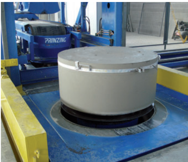
Entschalter Schachtunterteilrohling. Nach einer kurzen Aushärtezeit kann der Rohling in die Frässtation gebracht werden.
