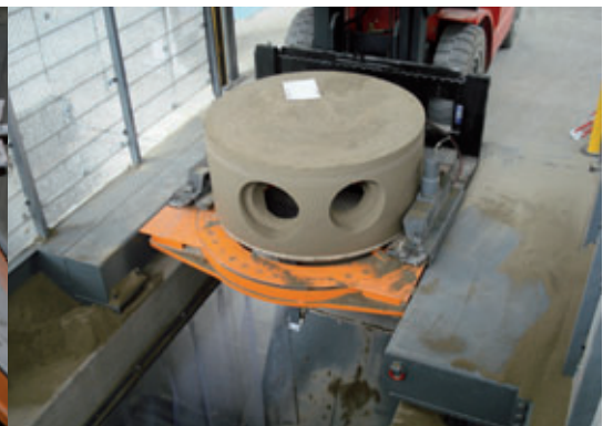
Entnahme des gefrästen Schachtunterteils aus der Primuss
