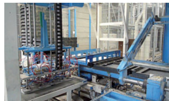
Die entschlachten Produkte werden auf ein Gurtband abgelegt.
