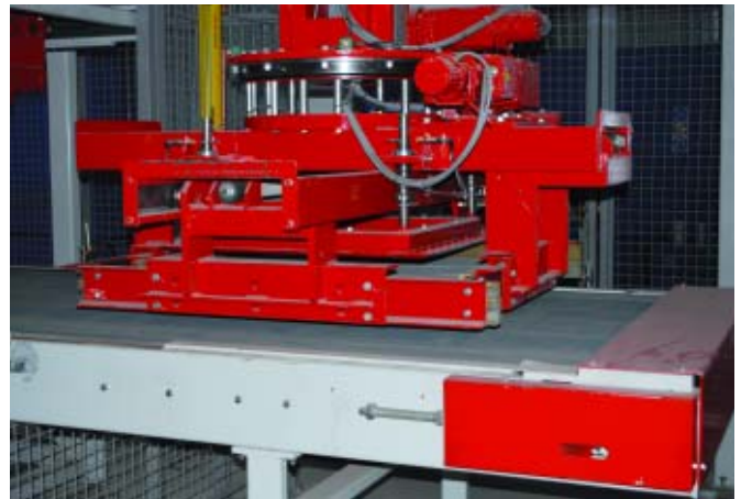
Слои изделий перекладываются на линию дробеструйной обработки
