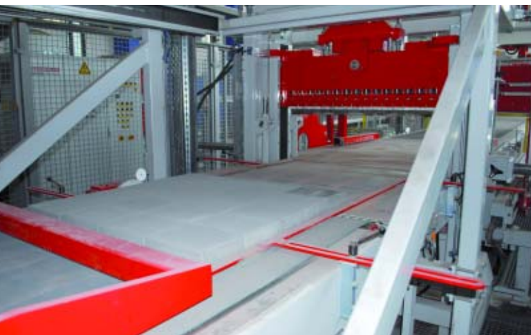
Каждый слой передвигается поочередно под нож сплиттера
